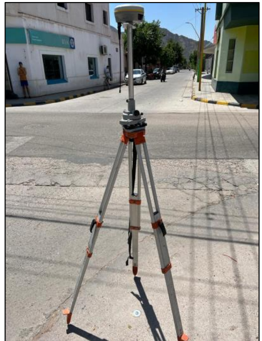
Figura N°19. Punto fijo colocado en un vértice de manzana que no posee cordón cuneta.
