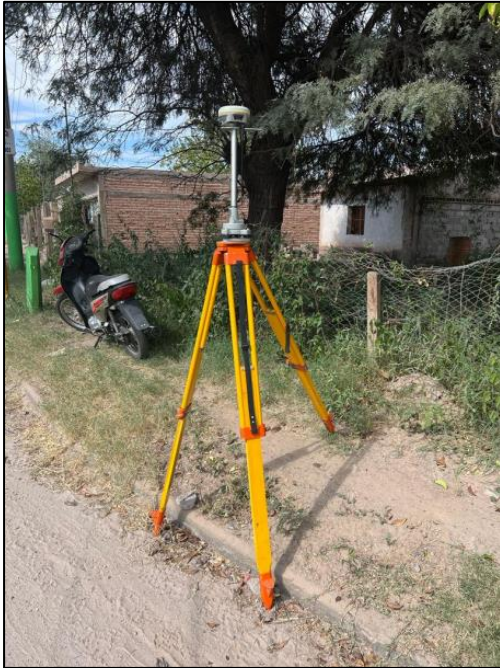
Figura N°18. Punto fijo que alrededor presenta gran cantidad de obstrucciones.
