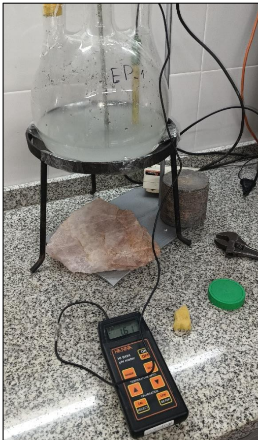
Figura 6.2.3: Medición de pH, Eh y temperatura.
