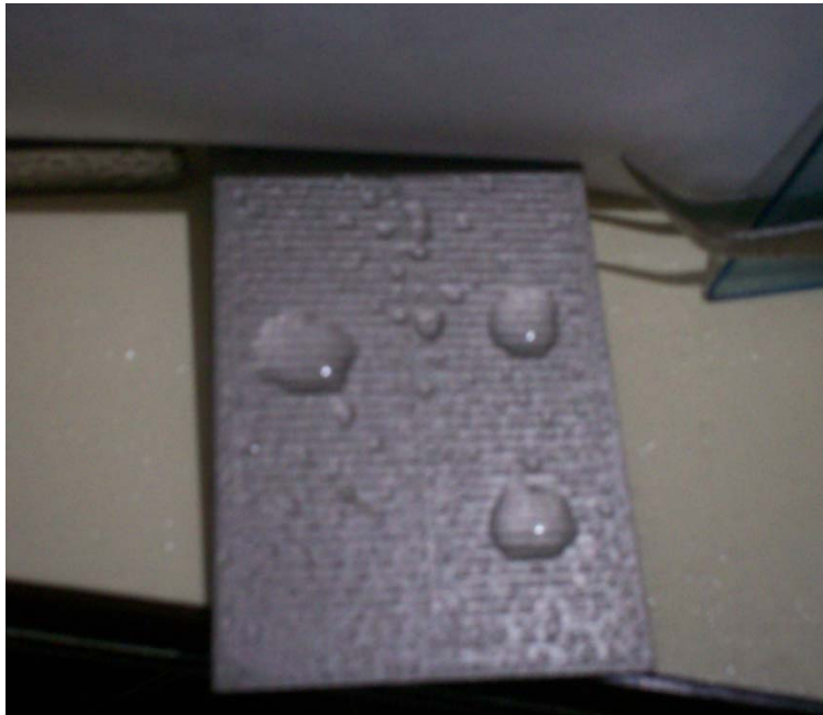
Fotografía 2: Área sensora totalmente humedecida con gotas de agua.
