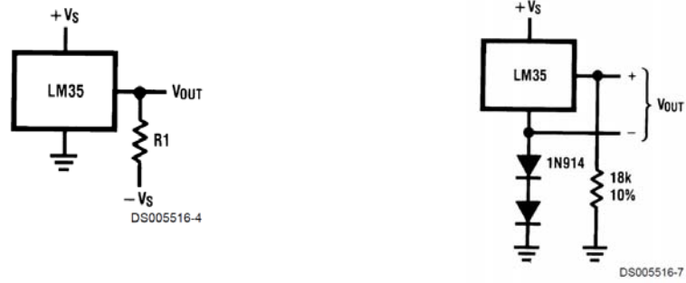
Figura 19: Sensor de temperatura. Izq.: con fuente simétrica; Der.: con fuente simple
