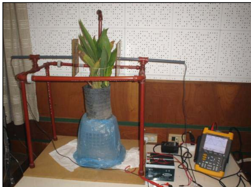
Figura 7: Sensor Capacitivo de Humedad de Suelo (INAUT)
