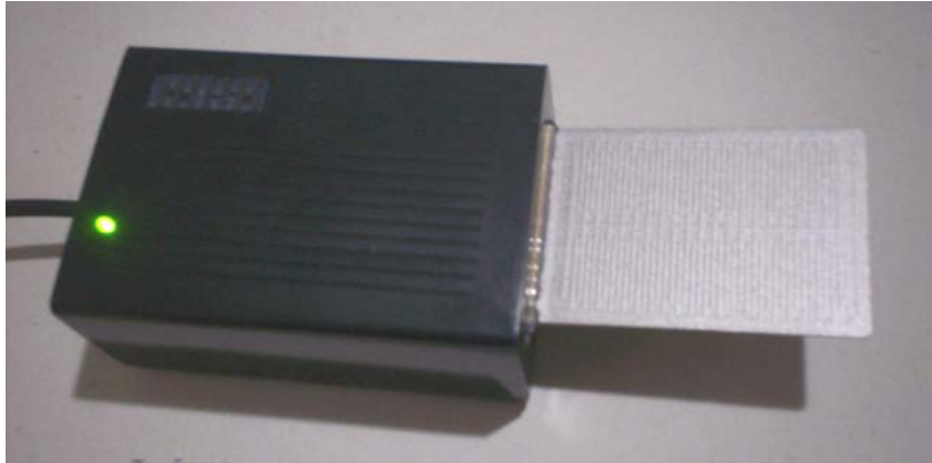
Fotografía 6: sensor SHH-1 capacitivo.
