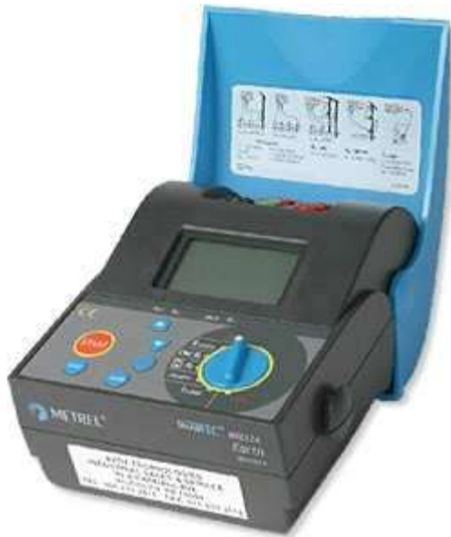
Figura 6. Telurímetro METREL MI2124
