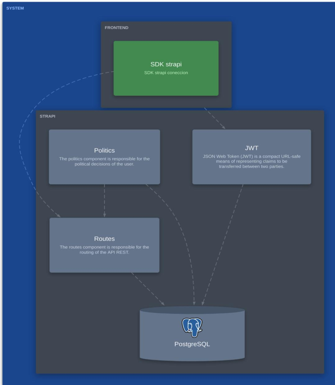
Figura 4-7 Diagrama Contenedor - Muestra los componentes del Backend del sistema (Elaboración propia).
