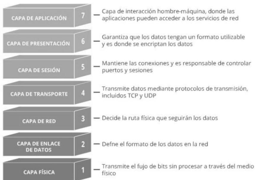
Figura 2.4. La Pila OSI.
