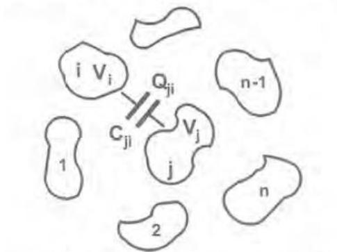
Figura 2.9. Representación fundamental de la capacidad entre conductores.
