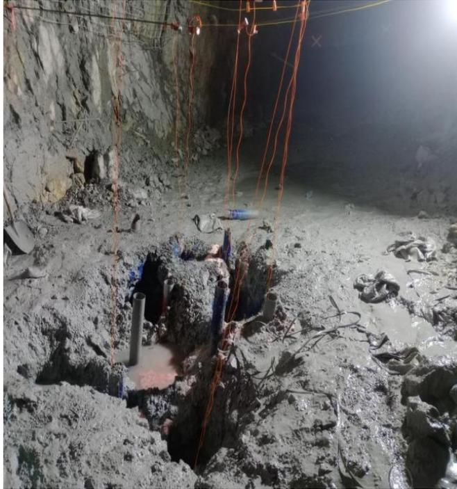
Imagen N°12: Carguío de explosivo y verificación del circuito finalizado
