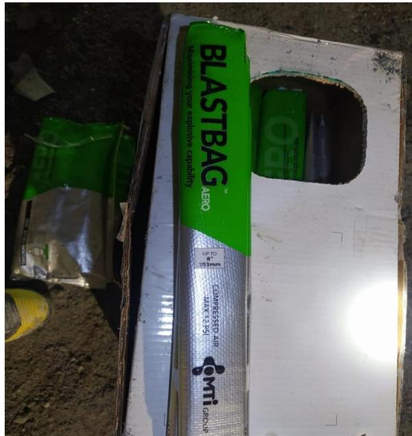
Imagen N°9: Bolsa de aire de alta resistencia para taco inferior y superior
