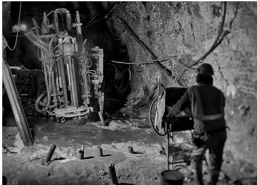
Imagen N°4: Equipo cubex orión en proceso de perforación
