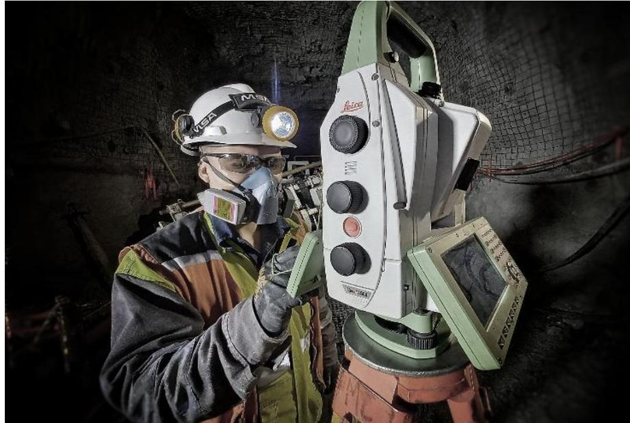
Imagen N°8: Topografía nivelando estación total
