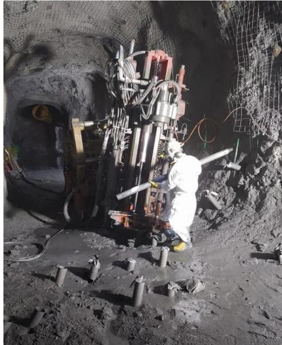
Imagen N°2 : Ayudante agregando una barra a la sarta de perforación
