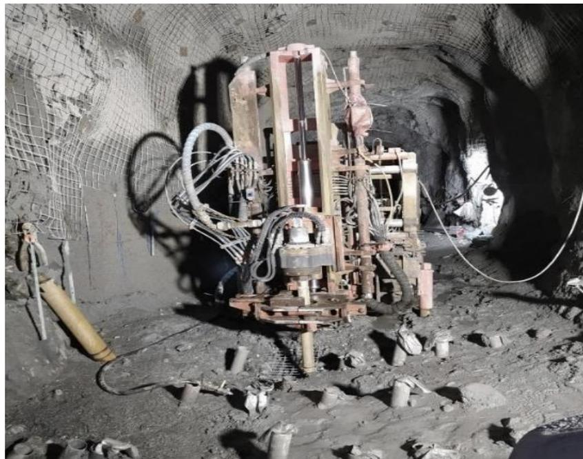
Imagen N°5: Equipo en perforación, taladros finalizados cubiertos con bolsa arpillera
