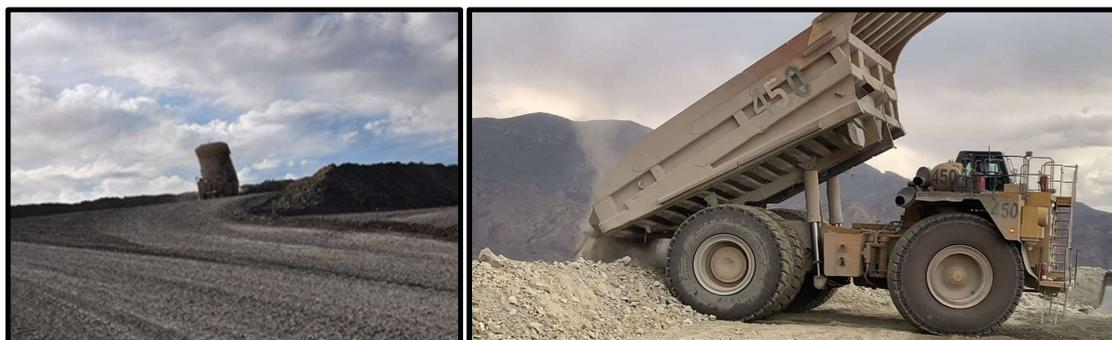
*Figura 15 - Descarga de material benigno por camiones CAT 793 en botadero. Izquierda descarga en superficie y derecha descarga en talud.*
