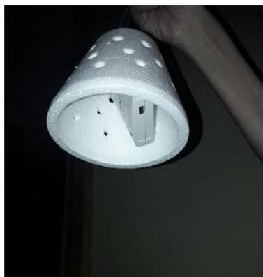
En los pasillos y hall de ingreso se colgaron los HOBOS desde el techo de losa maciza a una distancia de 0.30 m. y en los consultorios y patio cívico se colocaron en paredes separadas de las mismas 0.30 m mediante gancho metálico. (Figuras 79 a 84)
