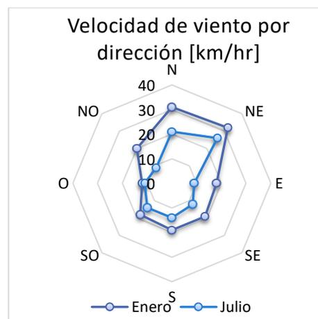
Figura 10: Velocidad del viento por dirección
