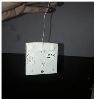
Los sensores se cubrieron con protecciones de poliestireno expandido perforados en toda su superficie y abiertos en su cara inferior a fin de evitar la incidencia y acumulación de calor radiante proveniente de lámparas, paredes o techo. (Figura 78)
