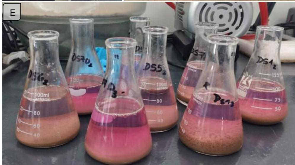
**Figura 15.** Fotografías tomadas durante el análisis de carbonatos. A) Ebullición en estufa durante 3 minutos. B) Muestras para titular. C), D) E) Valoración de exceso de ácido con solución de NaOH.
