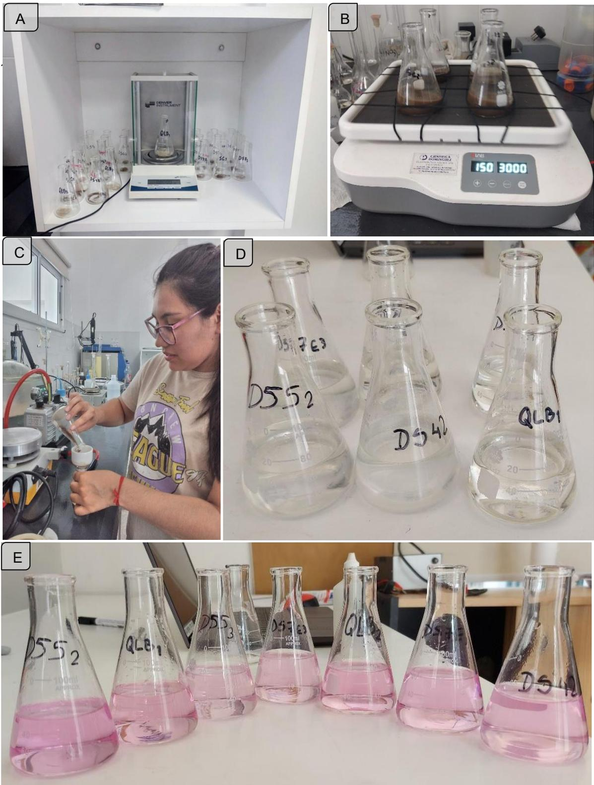
**Figura 16.** Fotografías tomadas durante el análisis de CIC. A) Pesaje de muestras, con balanza DENVER INSTRUMENT modelo TB-124A. B) Lavado y centrifugado de muestras. D) Muestras para titular. E) Muestras tituladas.
