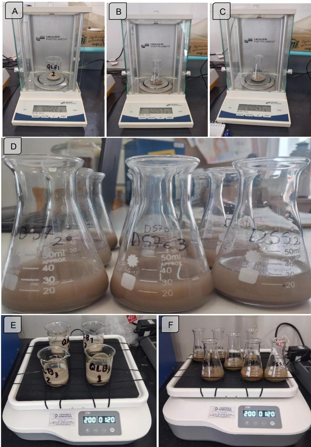
**Figura 9.** Fotografías tomadas durante la determinación de pH y CE. A), B), C) Pesaje de muestras con balanza DENVER INSTRUMENT modelo TB-124A. D) Suspensión de muestras. E), F) Muestras en agitador DLAB SK-0180-S.
