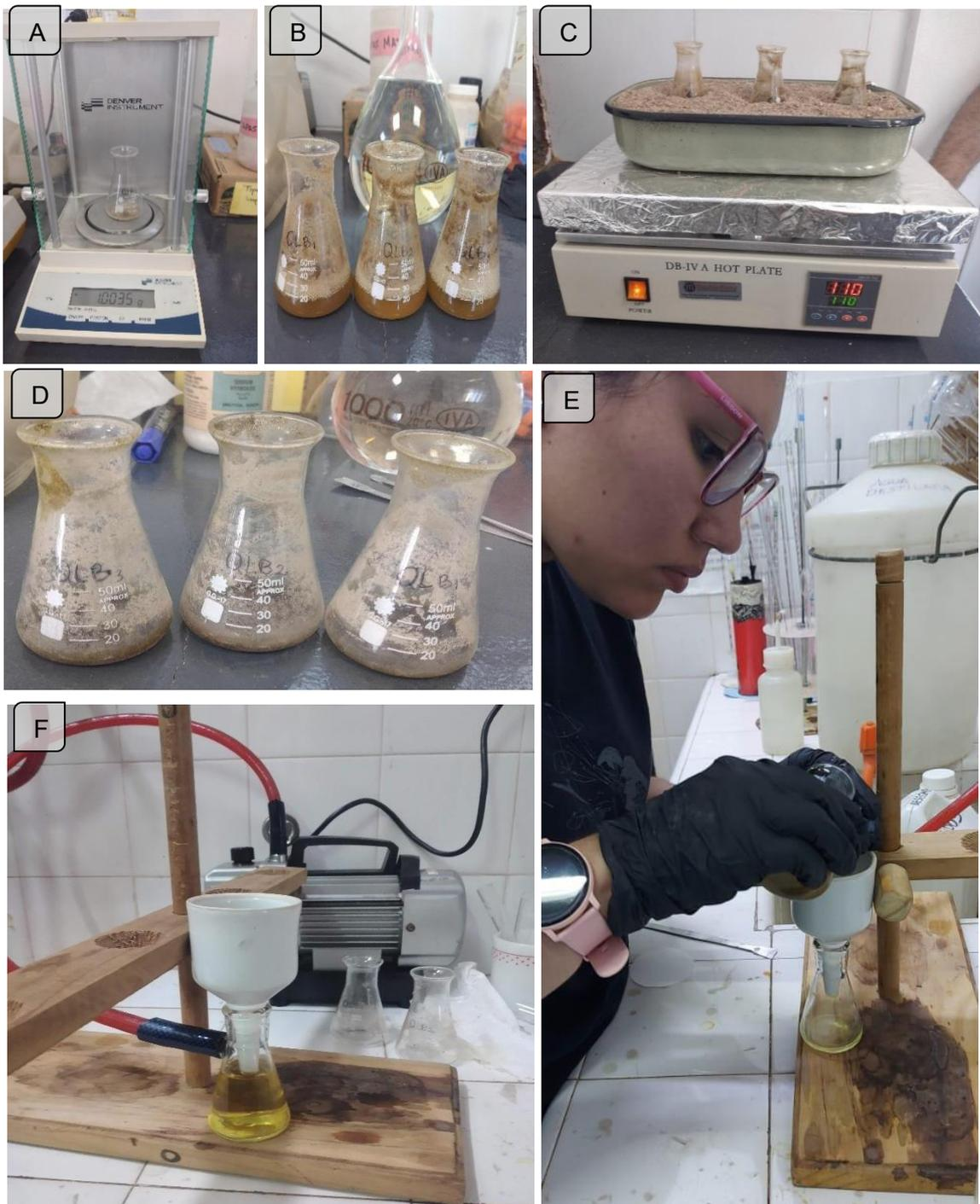
**Figura 11.** Fotografías tomadas durante el análisis de silicatos. A) Pesaje de muestras con balanza DENVER INSTRUMENT modelo TB-124A. B) Muestras durante la primera insolubilización con HCL. C) Muestras en baño de arena, se utilizó una placa calefactora digital, modelo DB-IV. E), F) Lavado y centrifugado de muestras con bomba de vacío.
