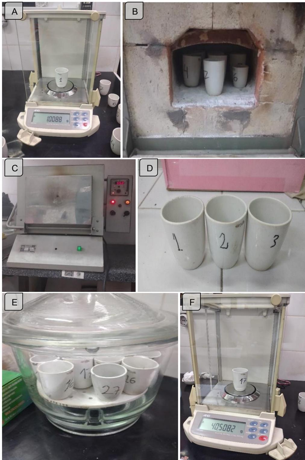
**Figura 13.** Fotografías tomadas durante el análisis de materia orgánica. A) Pesaje de muestras, con balanza DENVER INSTRUMENT modelo TB-124A. B), C) Muestras en horno mufla para su calcinación, a 550°C. D), E) Muestras posteriores a la calcinación y enfriamiento en desecador. F) Pesaje final de muestras.
