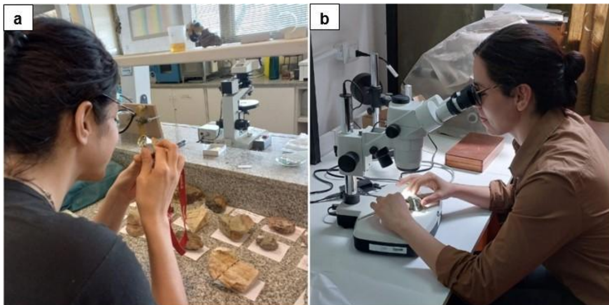
Figura 6.a) Selección de caras en muestras para la elaboración de cortes delgados en el Centro de Investigaciones en Ciencias de la Tierra (CICTERRA) de la provincia de Córdoba. b) Observación de muestras macroscópicas con lupa binocular Leica en el Laboratorio de Mineralogía de la Facultad de Ciencias Físico Matemáticas y Naturales (FCFMyN) de la Universidad Nacional de San Luis (UNSL).
