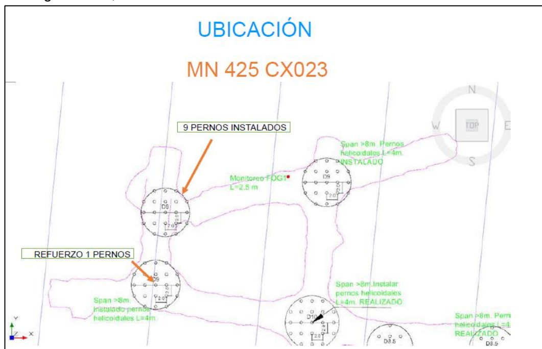
Figura N°47: MN_425. Ubicación pernos MDX instalados
