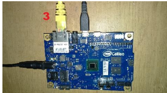
Figura 4-1 - Conexión ETH de la placa Intel Galileo.
