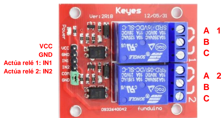
Figura 3-19 - Módulo relé 2 canales SRD-05VDC-SL-C
