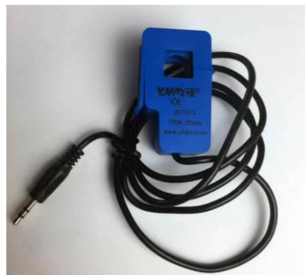
Figura 3-10 - Sensor de Corriente alterna SCT-013-000
