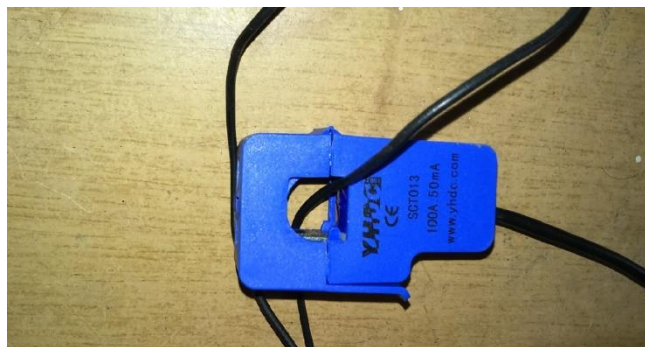
Figura 5-4 - Colocación sensor de corriente SCT-013
