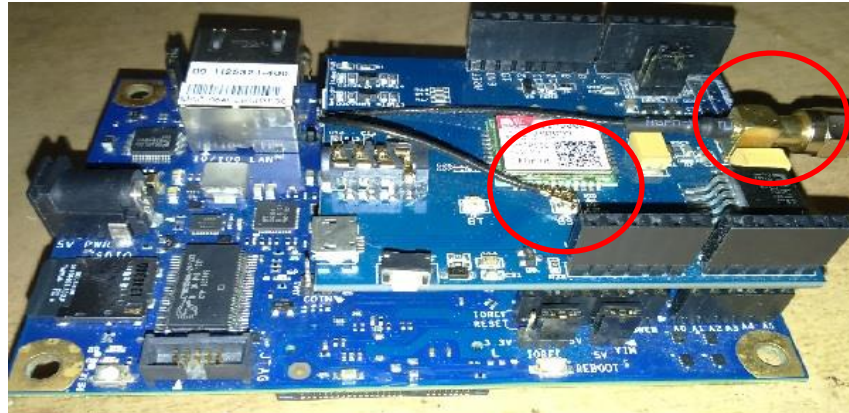
Figura 3-18 - Conexión SIM800C con Intel Galileo
