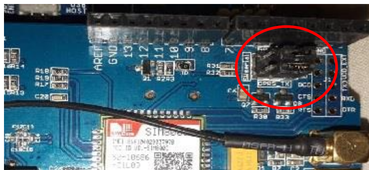
Figura 3-17 - Posición de jumpers de SIM800C
