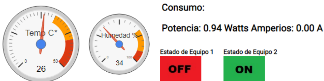
Figura 5-27 - Prueba del sensor SCT-013, pantalla Aplicación Web apagado
