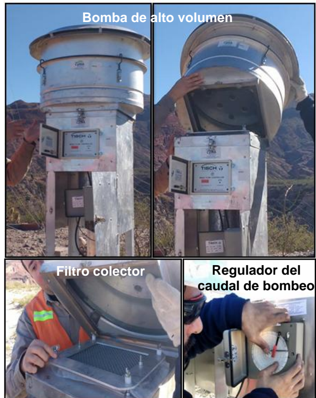
Fotografía 1: Equipo de medición de MP_{10} colocados por CyMA (subcontratada de MAA) en la estación de Hualfín.
