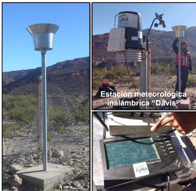
Fotografía 3: Recolector de MPS y estación meteorológica colocadas por CyMA en la estación Hualfín.
