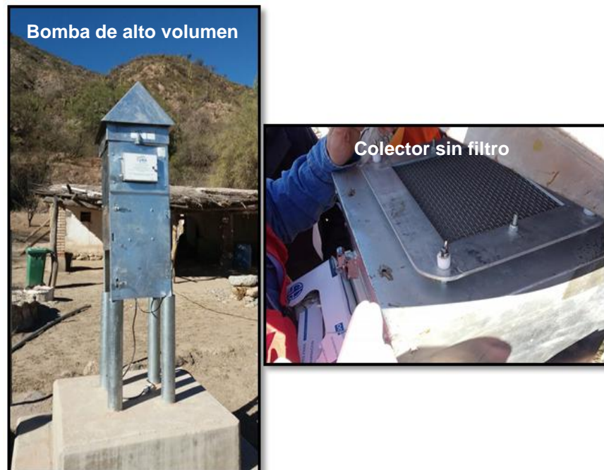
Fotografía 2: Equipo de medición de PTS colocados por CyMA en la estación Amanao.
