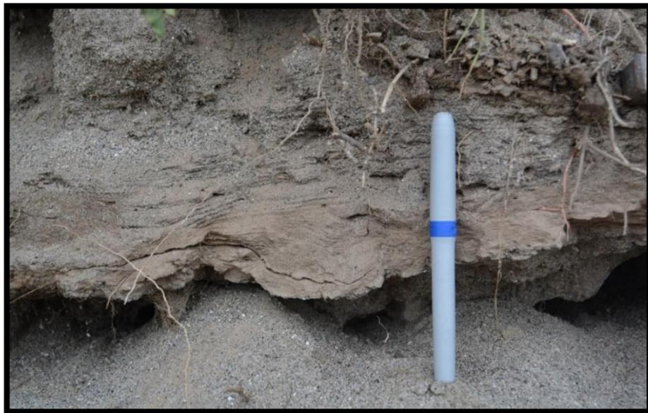
**Figura N° 14:** Estructura laminar en depósitos del río del Valle, localidad Las Tejas.
