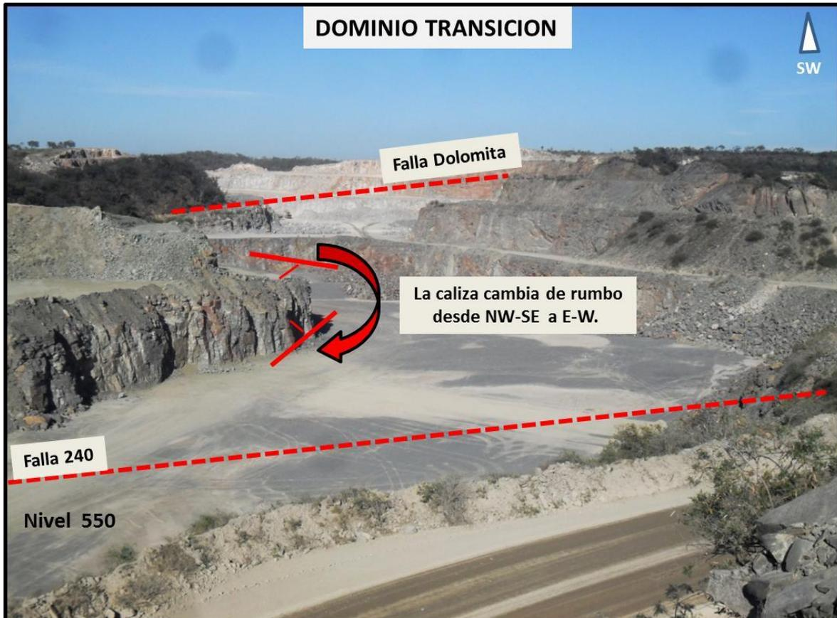
Figura 14\_Dominio Transición, núcleo del pliegue. Planta Catamarca – Cantera Doña Amalia. SMGA. 2014.
