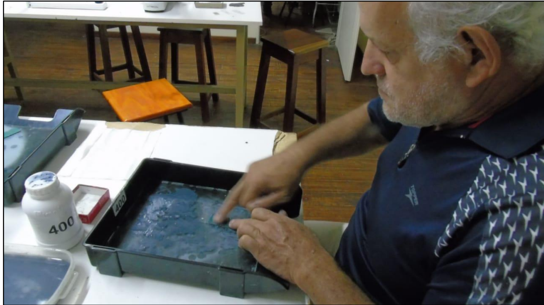
Figura 23 - Pulido de la muestra con abrasivo (carburo de silicio) #400.
