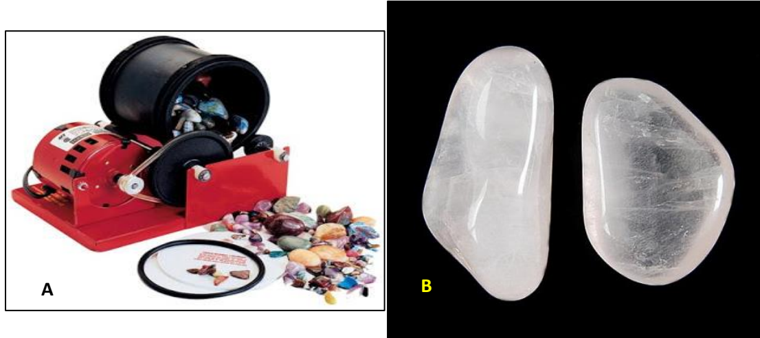
Figura 40 – A) Máquina tamborileadora. B) Cuarzo tamborileado.
