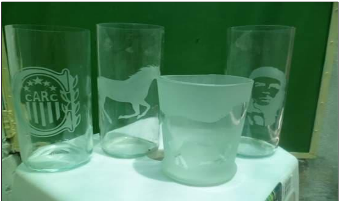
Figura 38 - Esmerilado a presión con arena de sílice.
