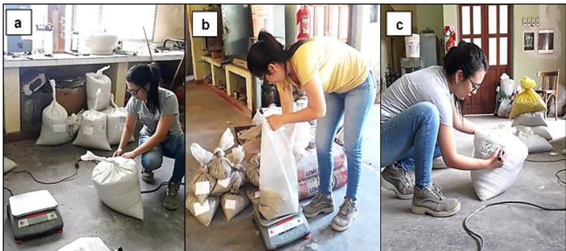
Foto N° 21 – Pesado y embalado del material necesario para elaborar cada pastón. (a) y (c) Rotulado y pesado de granulado pómez. (b) Pesado y rotulado del cemento.
