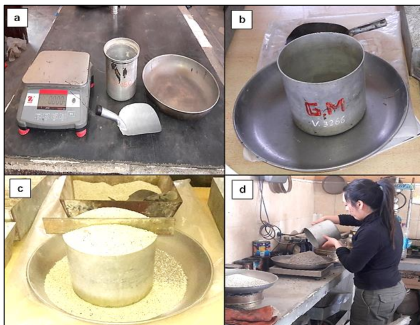
Foto N° 7 - (a) Materiales usados para realizar el ensayo. (b) Recipiente metálico plano que tiene ubicado en su centro el recipiente redondo de volumen conocido. (c) Recipiente enrasado mediante el uso de una regla metálica (d) Proceso de vaciado del recipiente y pesado del contenido en el mismo.
