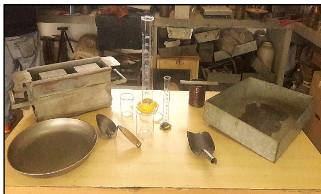
Foto N° 18 – Materiales usados para elaborar los bloques de hormigón con molde metálico.
