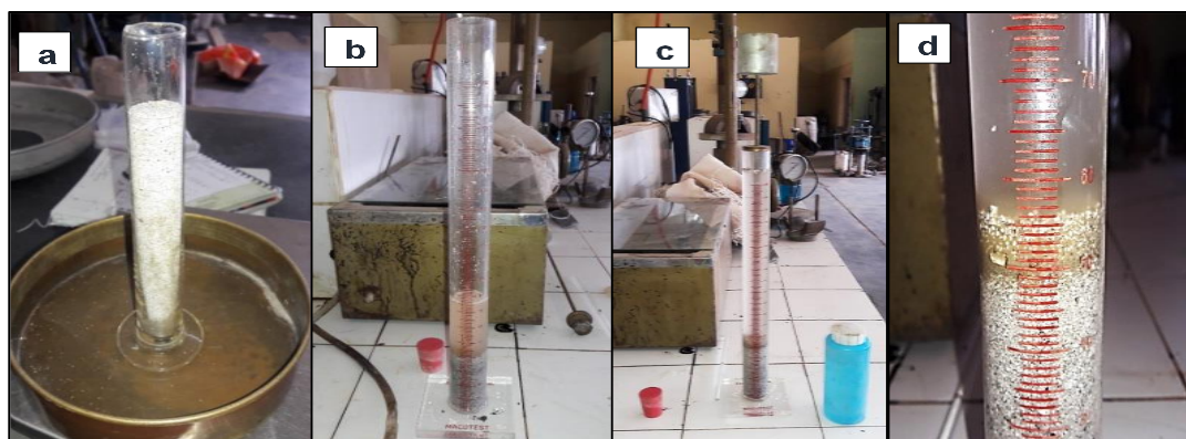
Foto N° 10 – Procedimiento realizados para determinar el Equivalente de arena de las diferentes muestras.
