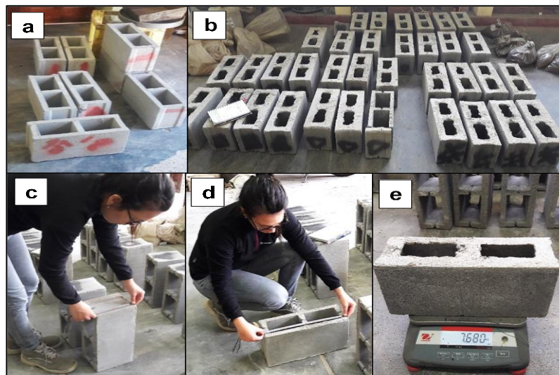
Foto N° 24 – (a) Bloques realizados usando un molde metálico y corte manual. (b) Bloques realizados usando bloquera eléctrica. (c), (d) y (e) Medición de parámetros de cada unidad de hormigón realizada.
