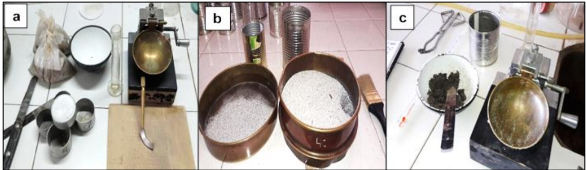
Foto N° 9 – (a) Materiales usados para realizar el ensayo. (b) Material tamizado en tamiz IRAM N°40. (c) Pasta de material cuyos extremos ya se unieron mediante los golpes del Casagrande.
