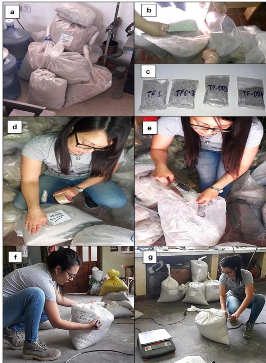
Foto N° 5 – (a) Muestras depositadas en gabinete. (b)y(d) Proceso de cuarteo, embalaje y rotulado de las muestras para ser enviadas al laboratorio de tratamientos químicos de la empresa Intercement – Loma Negras S.R.L. (e)-(c) Proceso de cuarteo, embalaje y rotulado de las muestras para ser enviadas al laboratorio de Mineralogía II y Petrología, de la Facultad de Tecnología y Ciencias Aplicadas, UNCa. (f)-(g) Proceso de cuarteo, pesado, embalaje y rotulado de las muestras para ser enviadas a bloquera donde se elaborarán los diferentes pastones y crearon bloques de hormigón.
