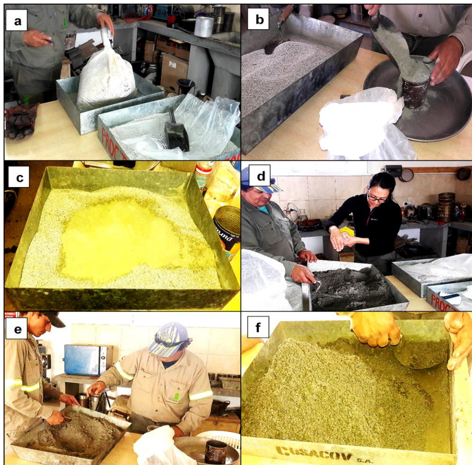
Foto N° 19 – Proceso de elaboración de los bloques de hormigón. (a) Descarga de material de cantera. (b) Medida de cemento usando el recipiente cuya capacidad es 860 ml. (c) y (d) Mezcla y homogeneización de los materiales secos. (e) y (f) Humedecimiento de la mezcla de hormigón.
