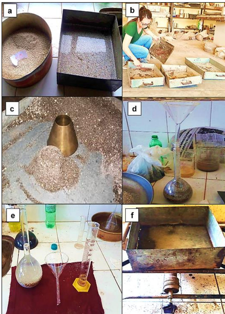
Foto N° 11 – (a) 1000 gr de muestra humedecida 24 hs. (b) Muestra esparcida en latas rectangulares metálicas para iniciar el proceso de secado al aire. (c) Cono metálico para probar la humedad requerida. (d) 100 gr de material a humedad seca al aire colocadas mediante un embudo de vidrio en matraz. (e) Matraz enrazado, cuyo volumen se anota como V_a . (f) Se trasvasa el material y se seca a volumen constante hasta peso constante, dato que se anota como P_s .
