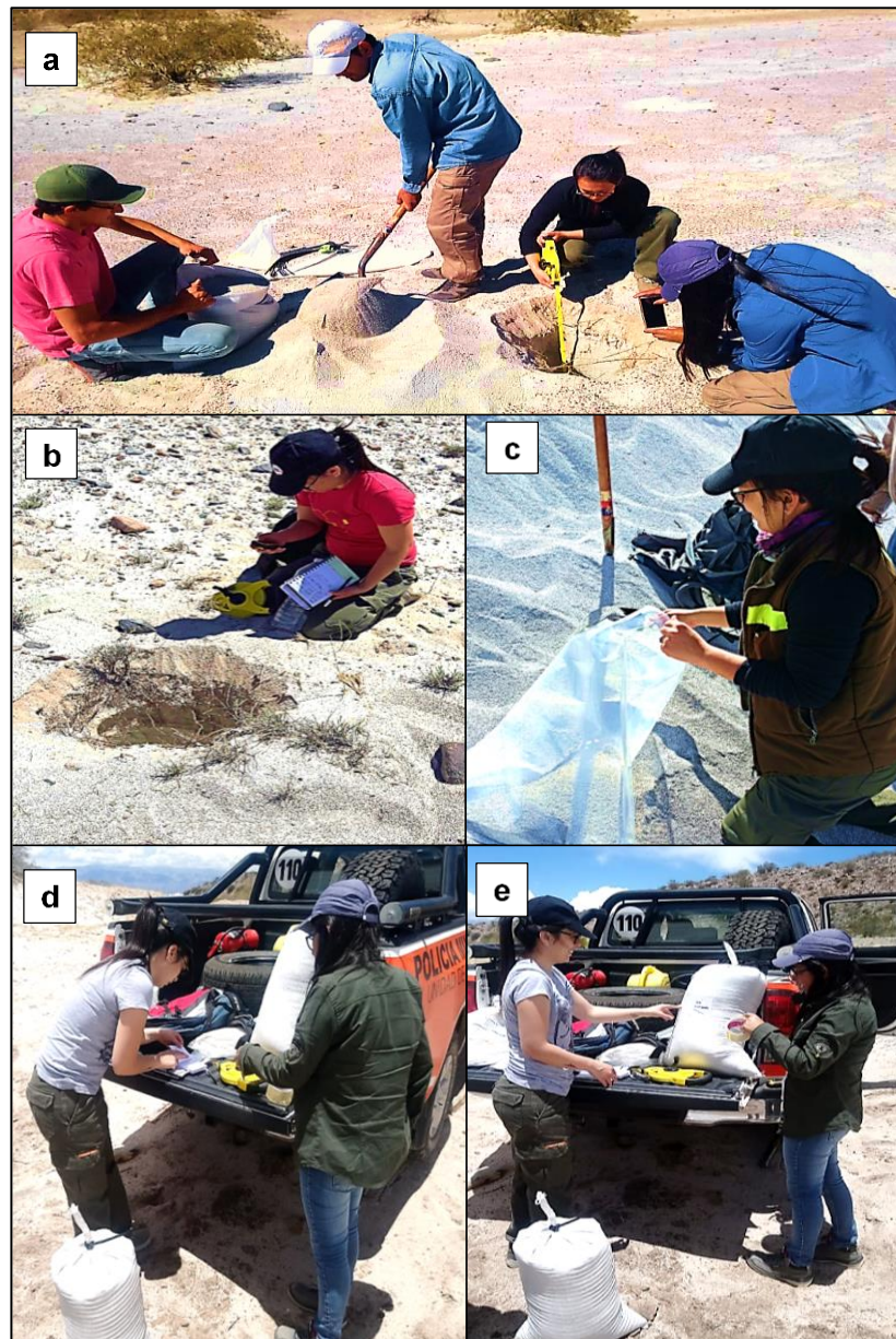
Foto N° 4 – Procedimiento de muestreo sedimentológico realizado en ambas campañas de campo, donde se utilizaron bolsas arpilleras (a) y plásticas (c). (b) Toma de del punto de muestreo sedimentológico, usando GPS convencional. (d) Proceso de embalado y rotulado de las diferentes muestras, para ser debidamente trasladadas e identificadas en gabinete.
