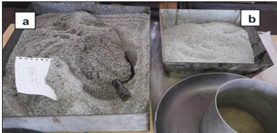
Foto N° 6 – (a) Muestras en condición de humedad natural. (b) Muestra seca a hasta peso constante.
