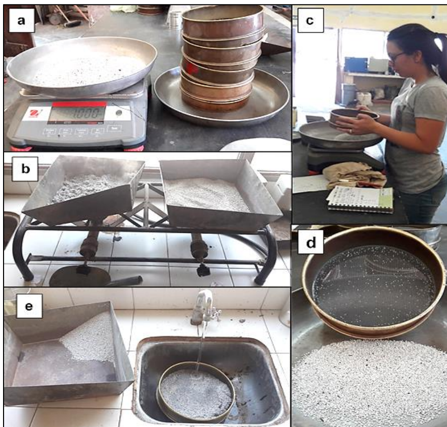
Foto N° 8 – Proceso desarrollado para tamizar el material.
