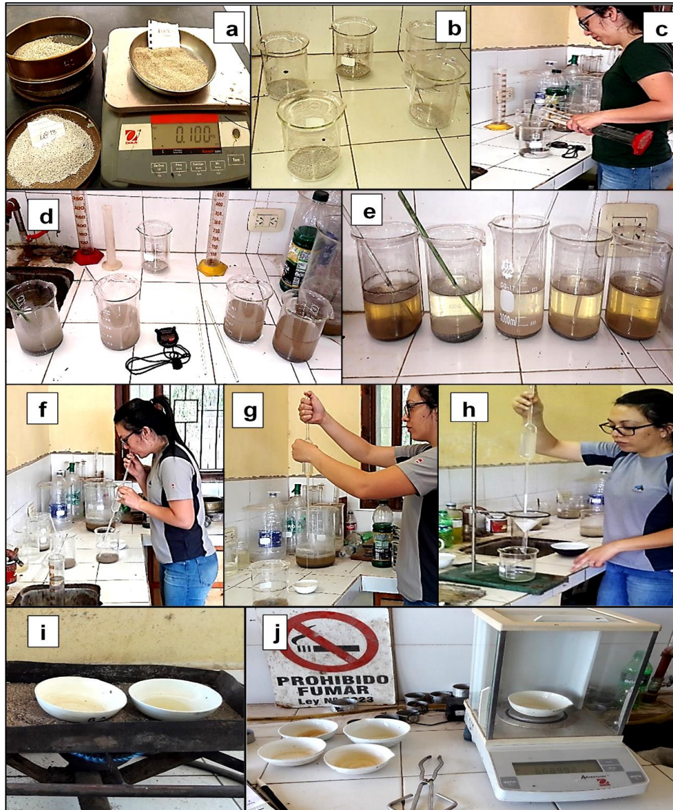
Foto N° 12 – Procedimiento para determinar el contenido de sales solubles en las muestras.
