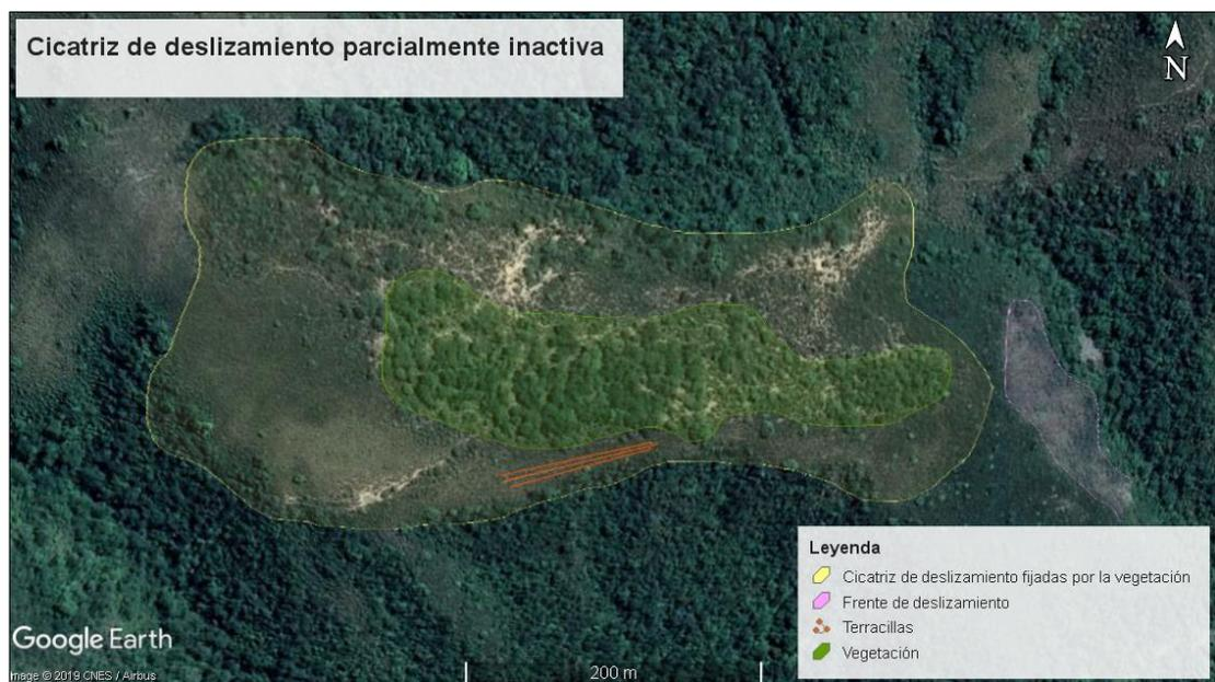
**Fig.32-** Cicatriz de deslizamiento parcialmente inactiva en la sección media de la cuenca, fijada por la vegetación. (28°24'37.40"S, 65°54'25.01"O)
