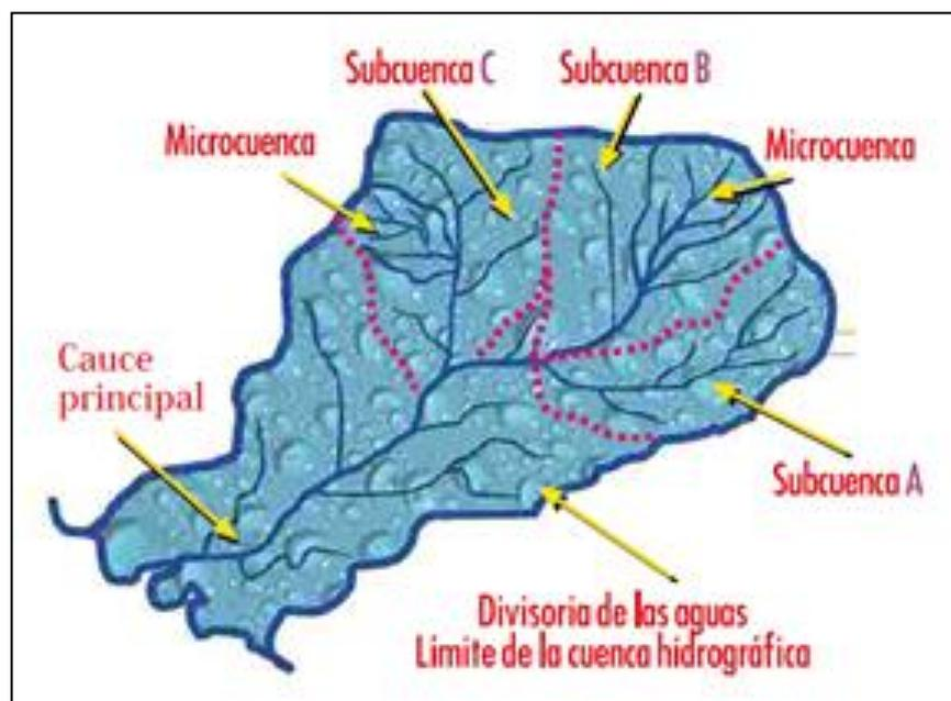
**Fig.12-** Elementos que componen una cuenca hidrográfica. Tomado de:
