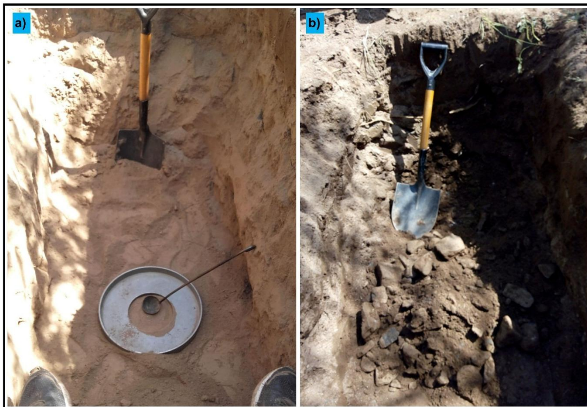
Foto 12: Calicatas por sector: a) Sur b) Norte
