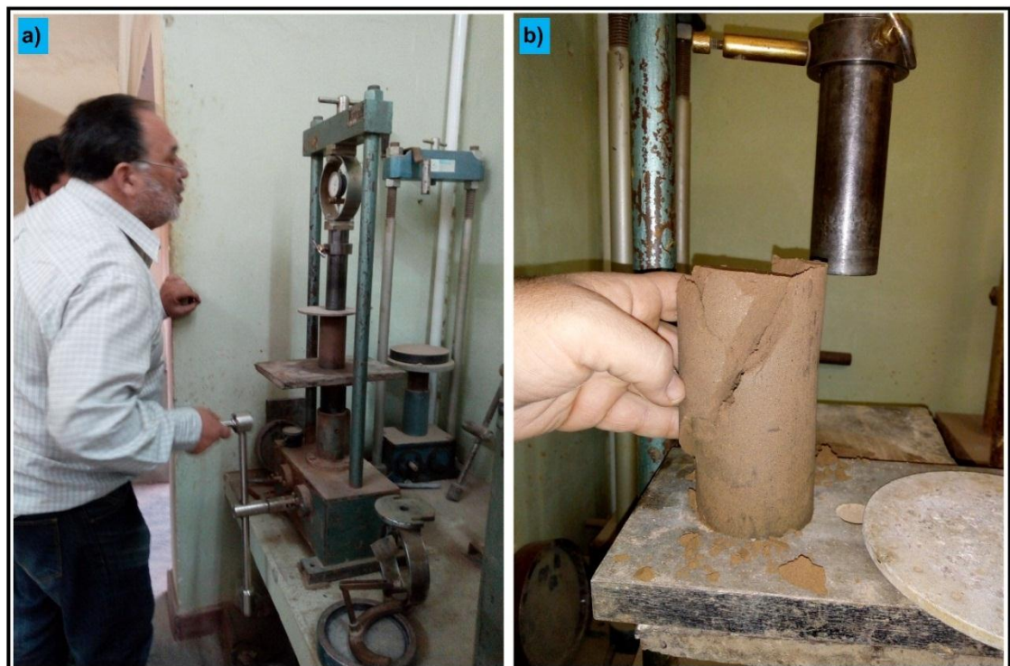
Foto 32: a) Preparación y llenado de probeta b) Proceso de compactado c) Pesado y medición de la probeta.
