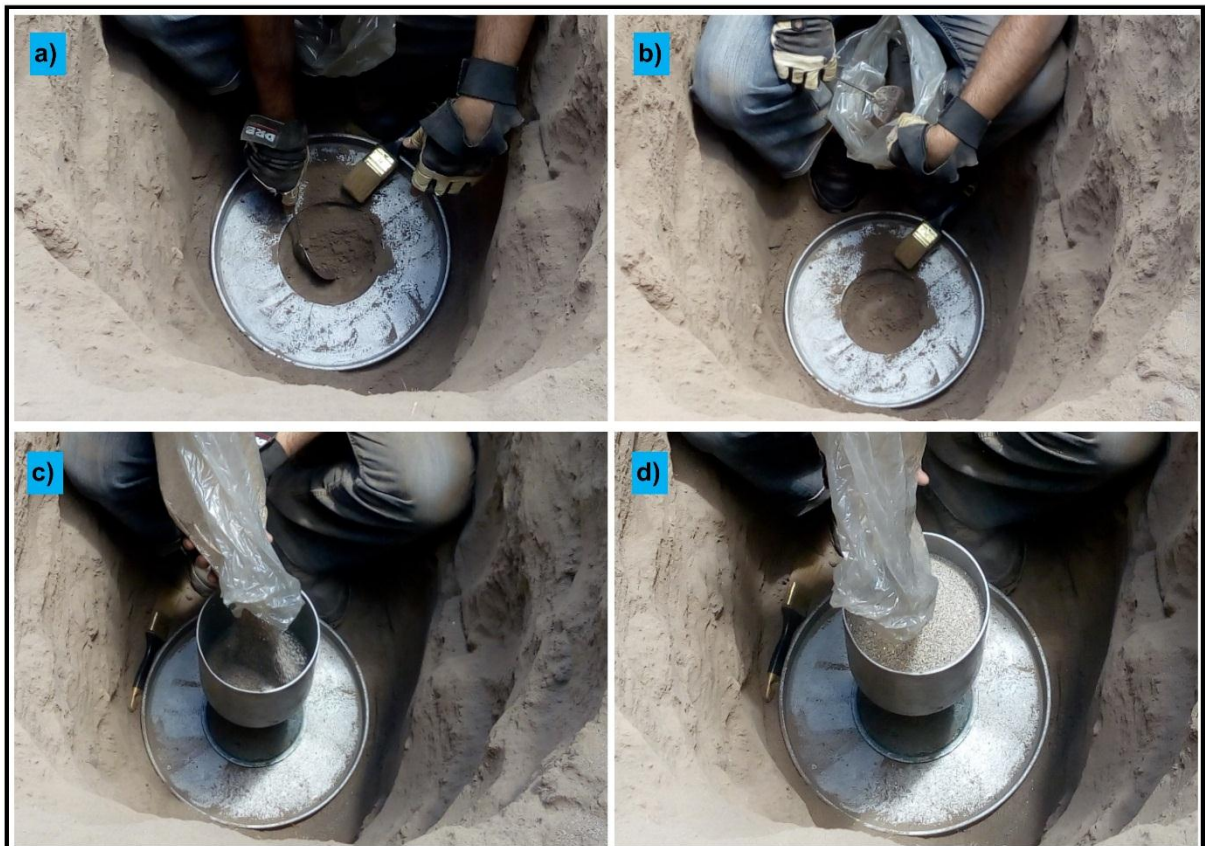
Foto 11: a) y b) Preparación y sacado de muestra de suelo natural in situ c) Cono de arena ensamblado junto a la platina d) llenado de arena.
