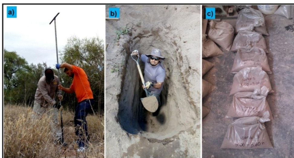
Foto 6: a) Ejecución de sondeo con pala helicoidal; b) Excavación de calicata; c) Bolsas de muestra rotuladas.
