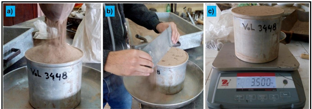
Foto 30: a) Recipiente lleno. b) Enrasado c) Peso del recipiente con la muestra.
