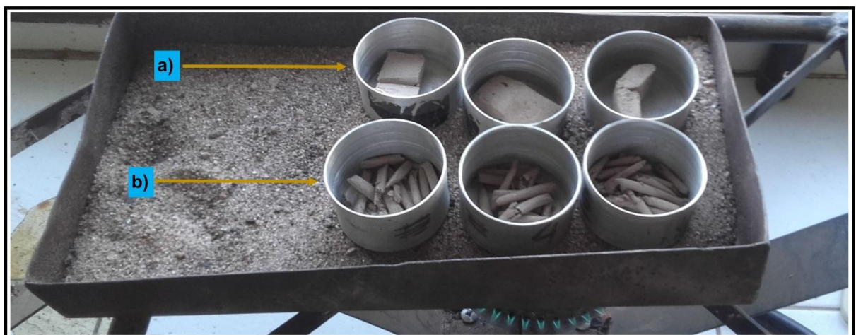
Foto 22: Proceso de secado límites de Atterberg a) Muestra de límite líquido; b) Muestra de límite plástico.
