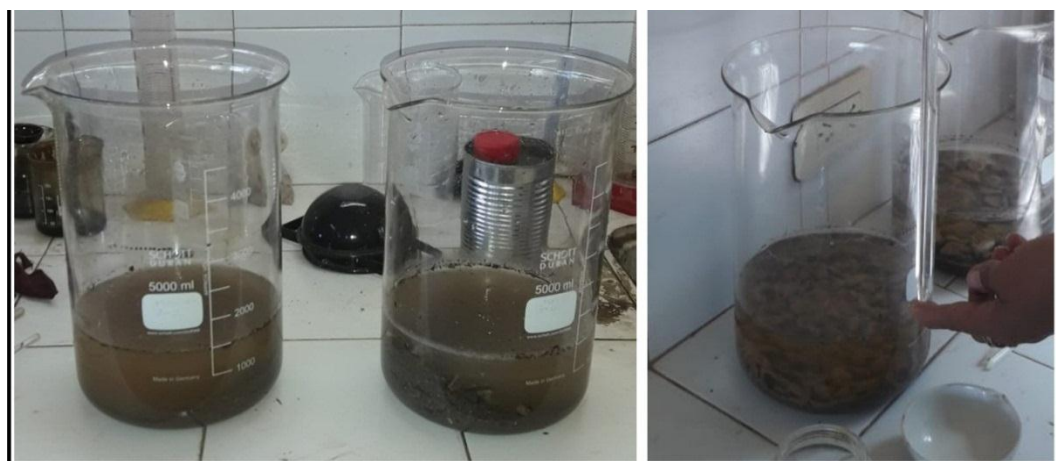
Foto 28: Muestra de suelo en reposo después de la agitación. b) Muestra de suelo sin presencia de floculación, 24 hs después.
