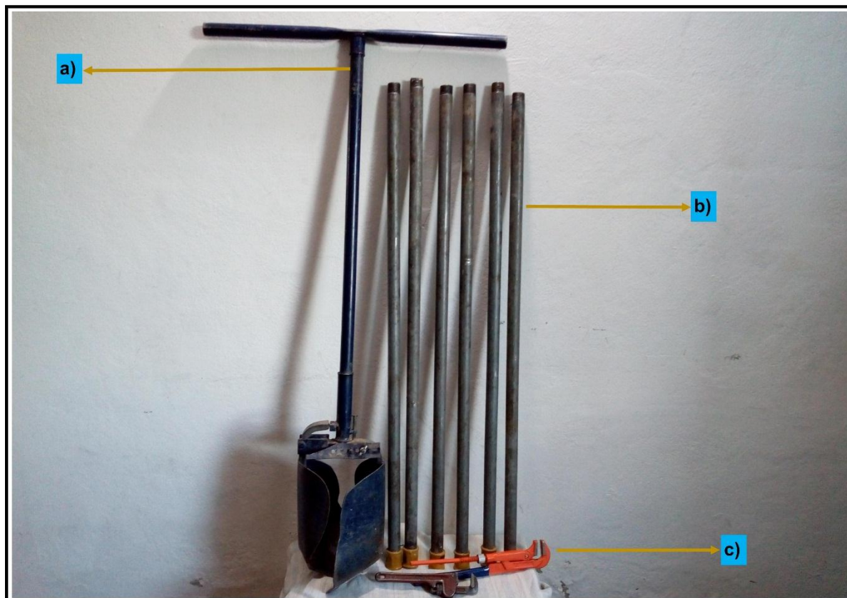
Foto 5: Herramientas para sondeos exploratorios por rotación manual, a) Pala Helicoidal b) Barras de acople c) llaves de ajuste.
