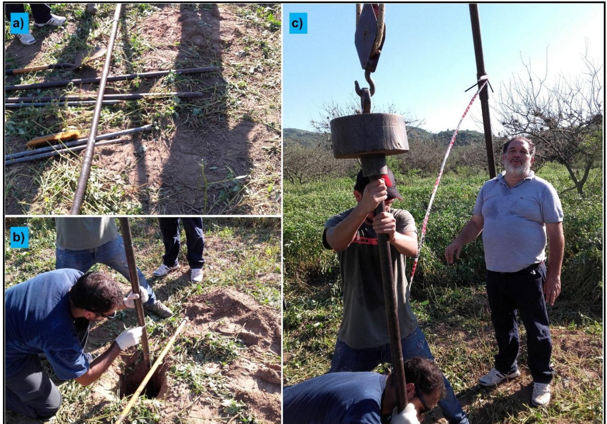
Foto 9: a) Barra de S.P.T. b) Demarcación de los 30 cm a hincar c) maniobra de golpeo.
