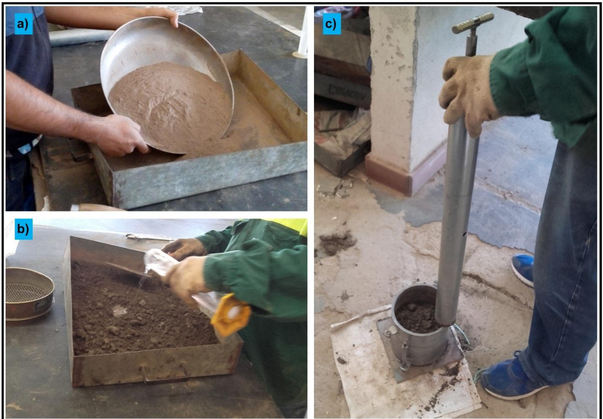
Foto 23: a) Preparación de muestra a peso estándar 2,500 kg; b) Muestra con el 10 % de agua del total de la muestra c) Golpes de la pesa en molde Proctor.
