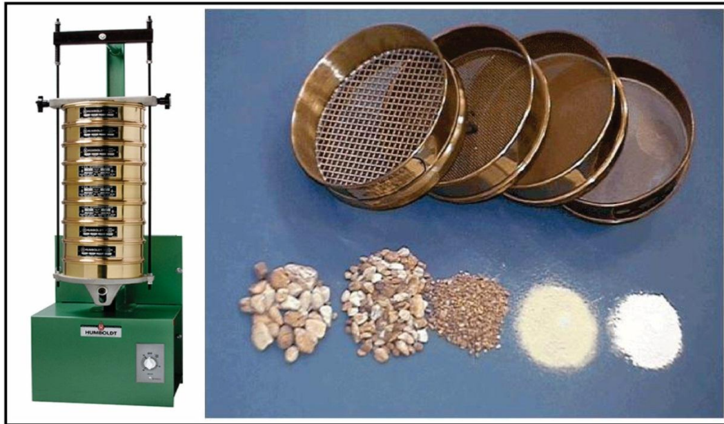
Imagen 11: Juego de tamices de mayor a menor diámetro (izquierda), se separan fracciones de grava, arena y arcilla que constituyen una porción de suelo (derecha) (Wikipedia).
