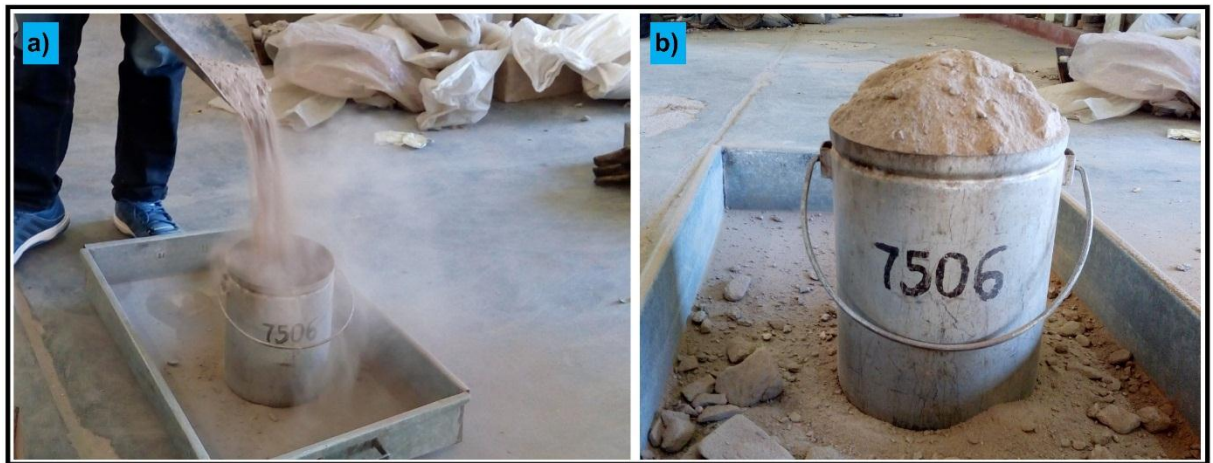
Foto 29: a) Muestra de suelo en recipiente de volumen conocido. b) Recipiente lleno.
