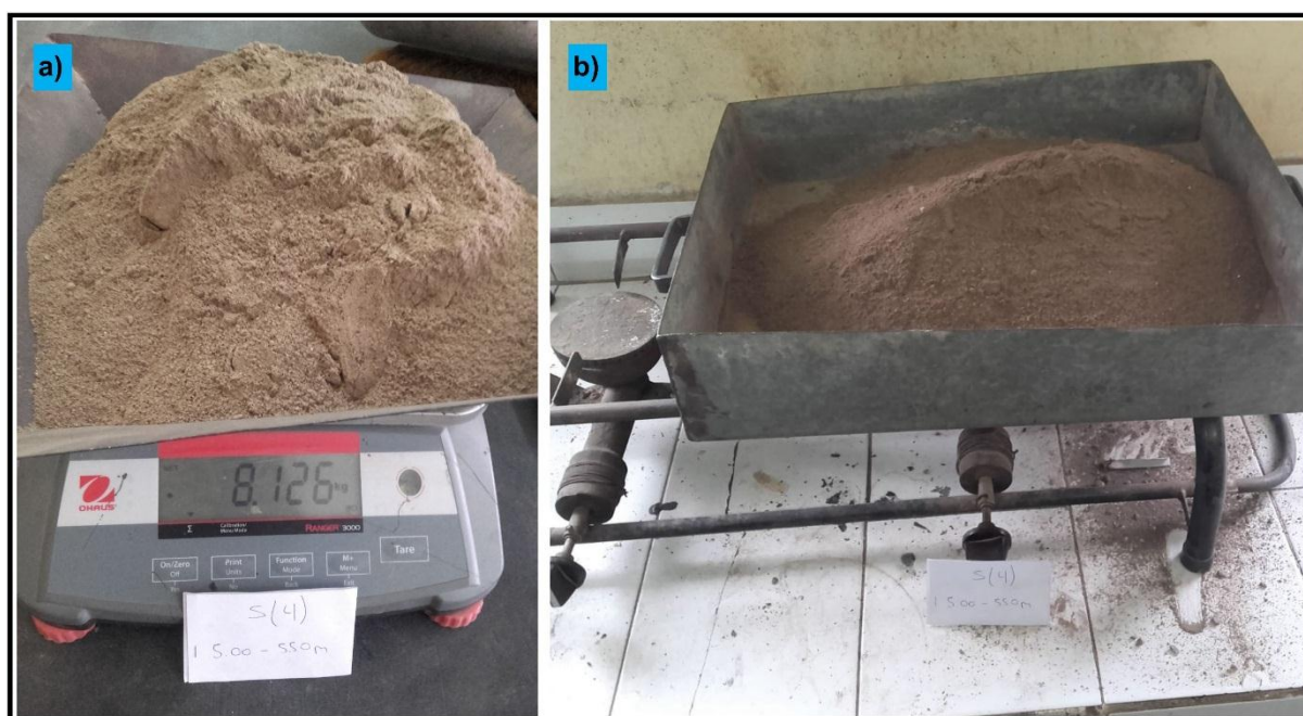
Foto 15: a) Pesaje de muestra granular húmeda. b) secado de muestra granular en estufa.
