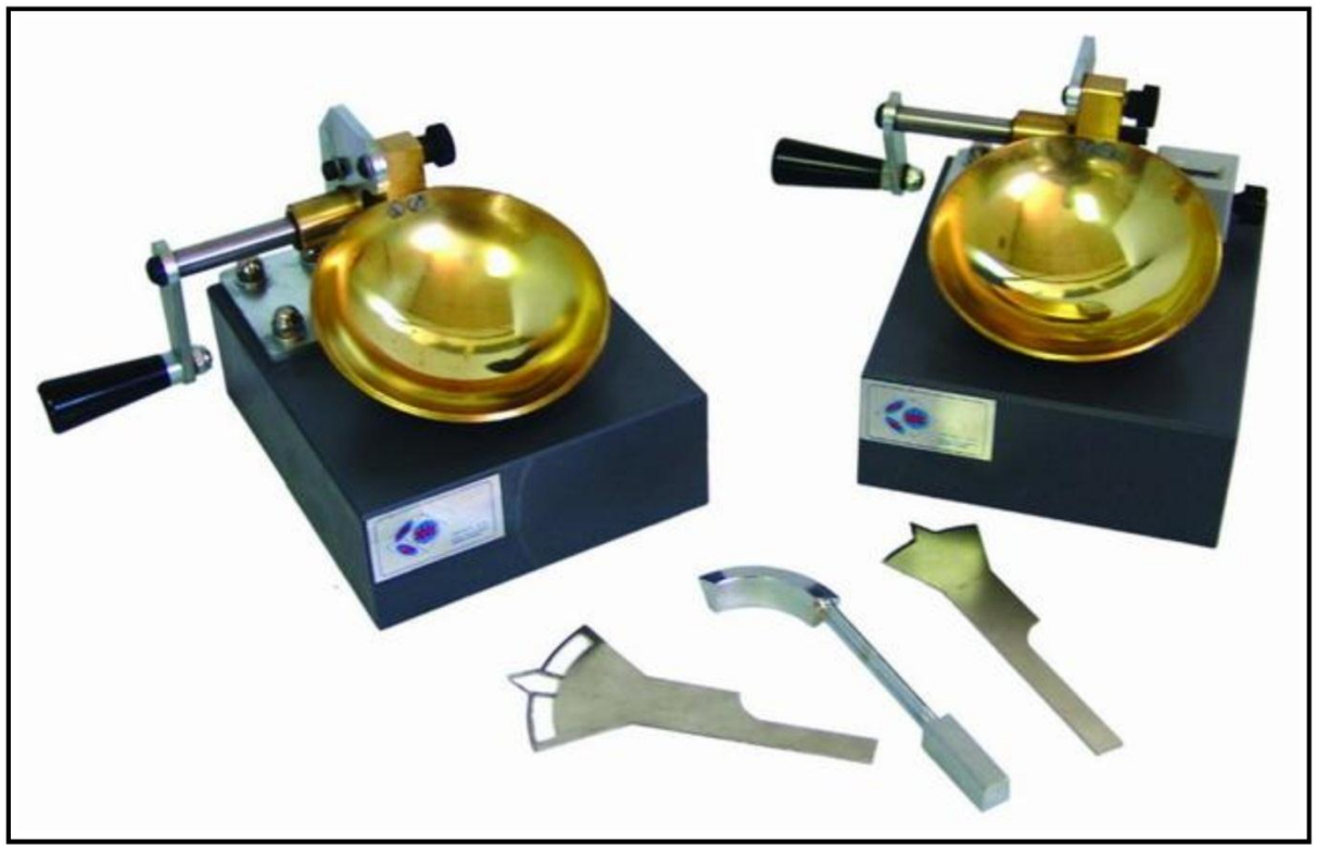
Foto 4: Tasa de Casagrande, aparato para determinar el W.L. (Juarez Badillo, 1996)
