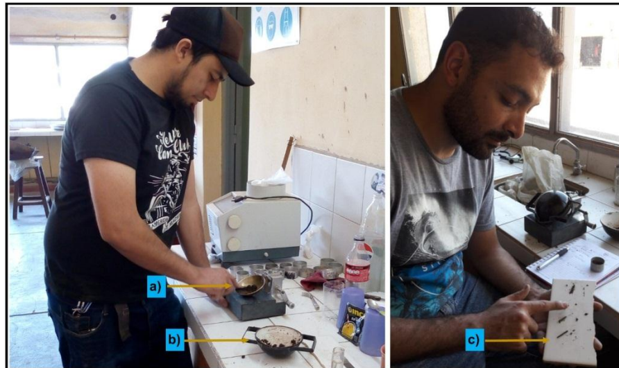
Foto 21: a) Determinación del límite líquido en cuchara de Casagrande b) Muestra sobrante c) Determinación del límite plástico.
