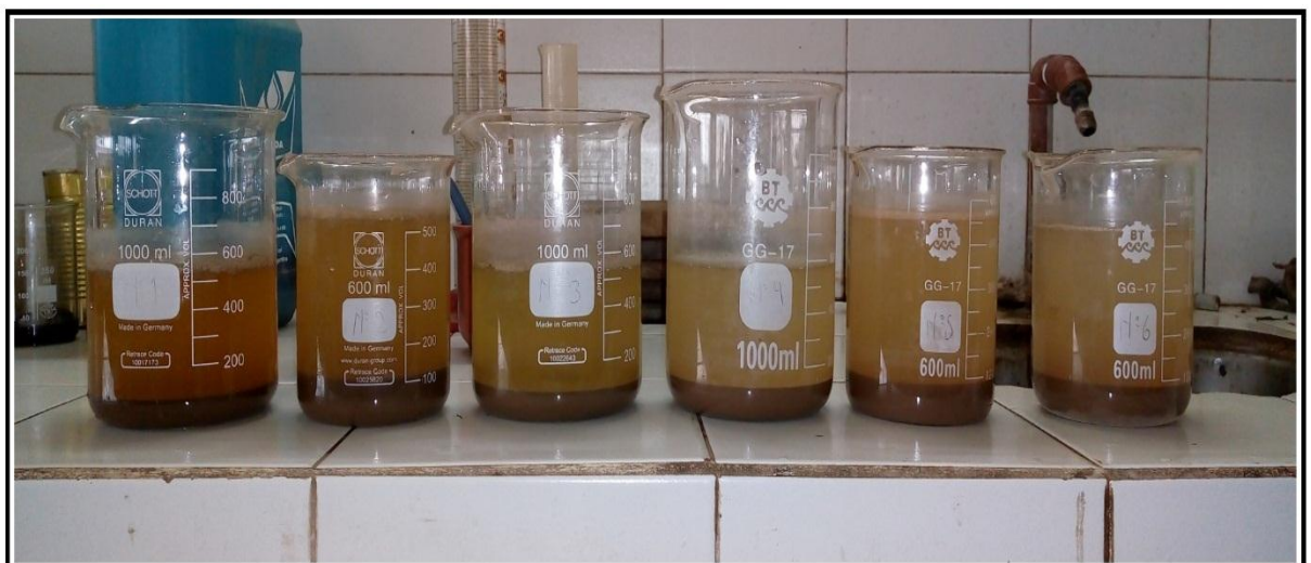
Foto 26: Sales de suelo fino sin floccular, 24 h después.
