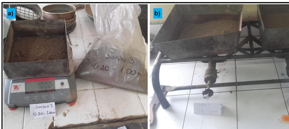
Foto 14: a) Pesaje de muestra húmeda. b) Secado de muestra en estufa.
