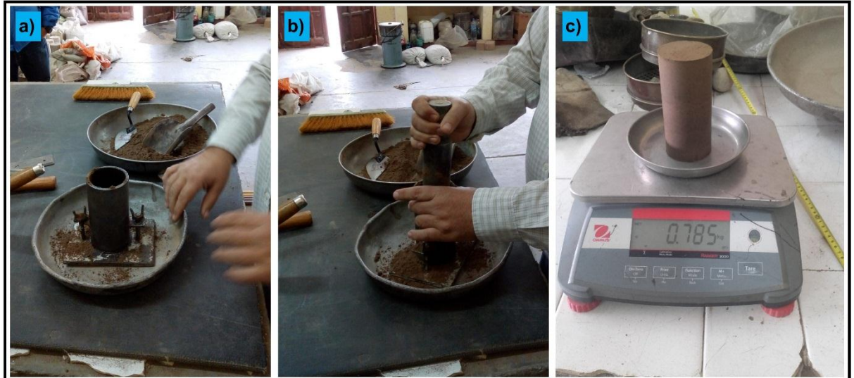
Foto 32: a) Preparación y llenado de probeta b) Proceso de compactado c) Pesado y medición de la probeta.
