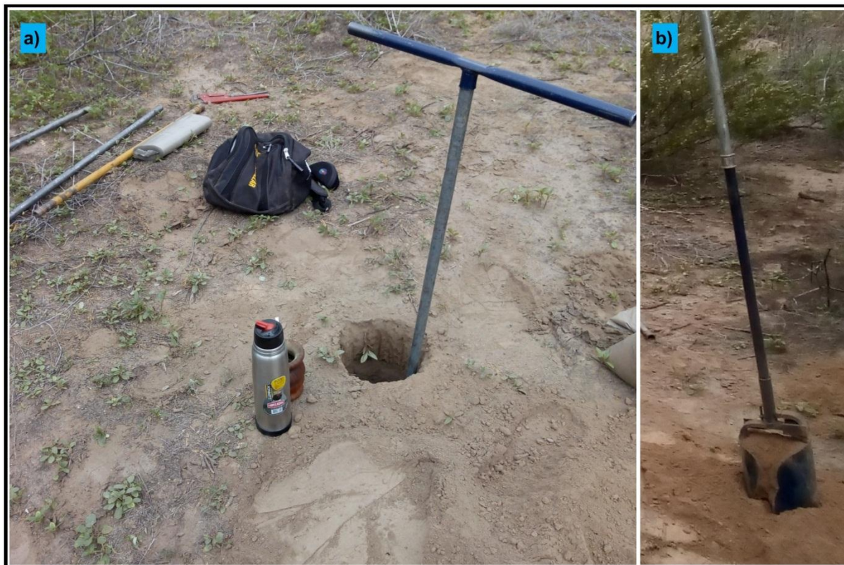
Foto 7: a) zona del sondeo b) sacando muestra mediante pala helicoidal.
