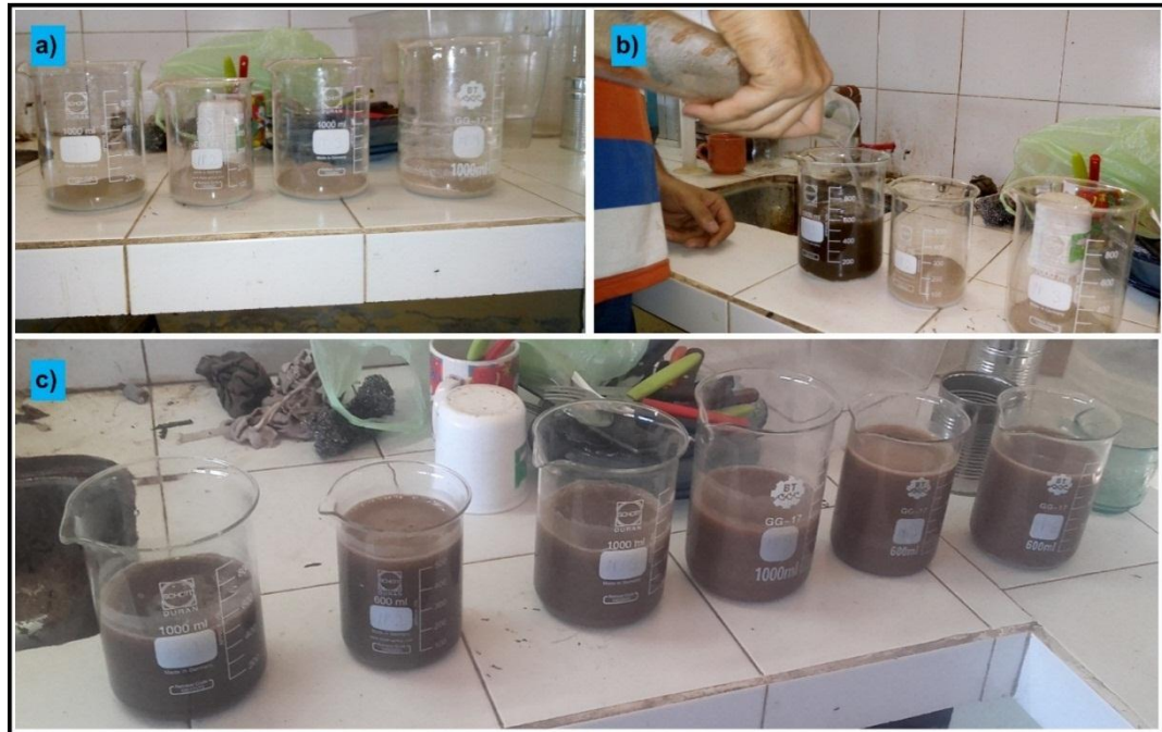
Foto 25: a) Muestras de suelo a determinar presencia de sales. b) Muestra con de agua destilada c) Muestra agitadas.
