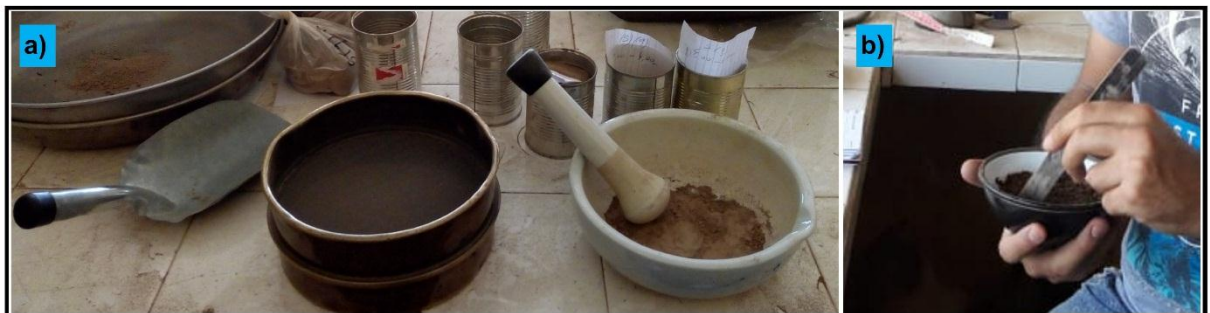
Foto 20: a) Preparación de muestra pasando por tamiz 40 previamente disgregada en mortero; b) Preparación de muestra húmeda en cápsula de evaporación.
