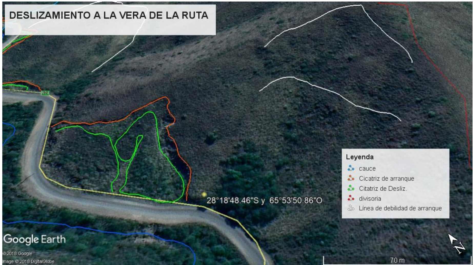
Figura 52: Deslizamientos de laderas en la zona cumbral de la subcuenca media.
