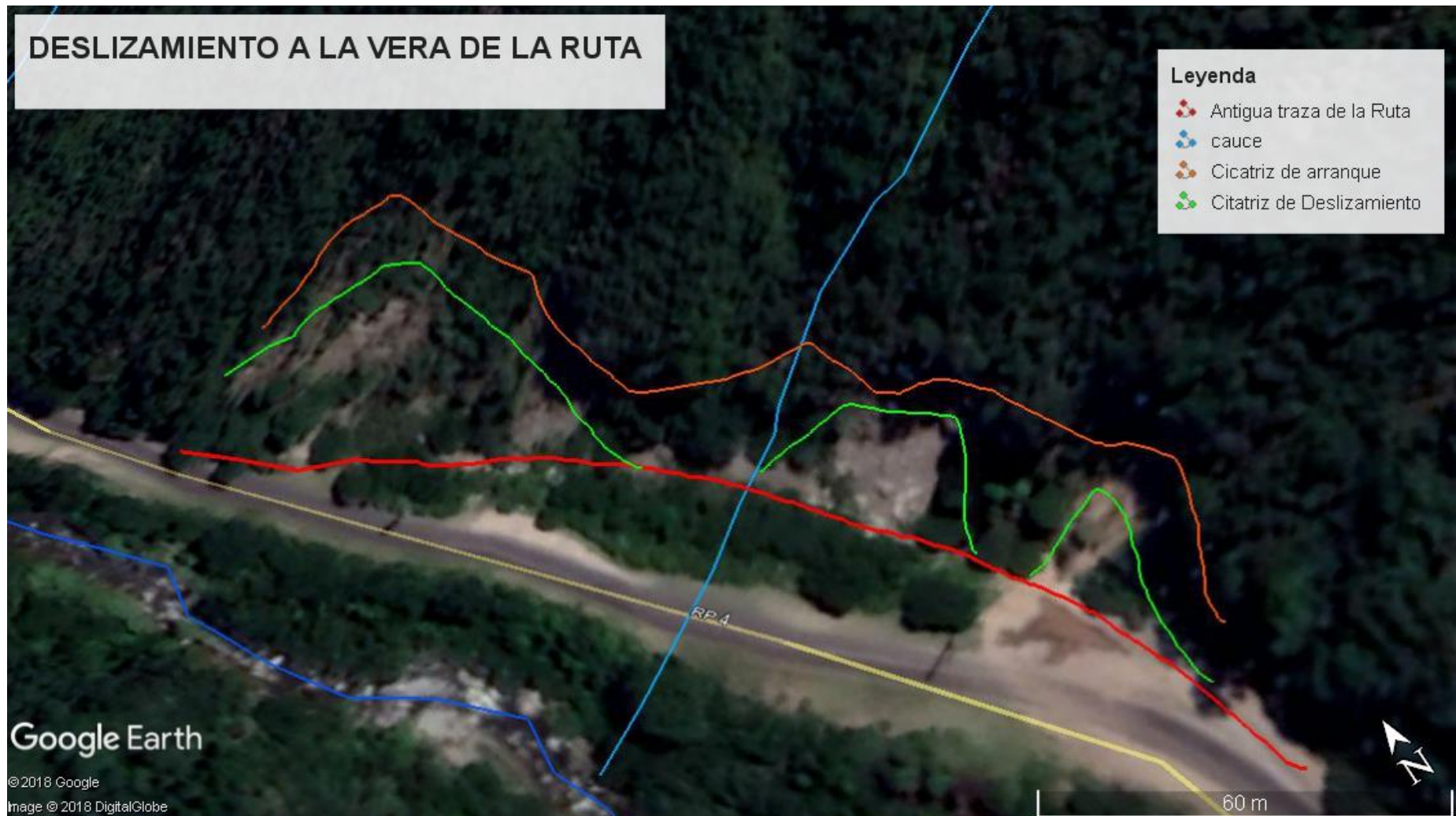
Figura 54: Deslizamientos de laderas en la zona cumbral de la subcuenca media.
