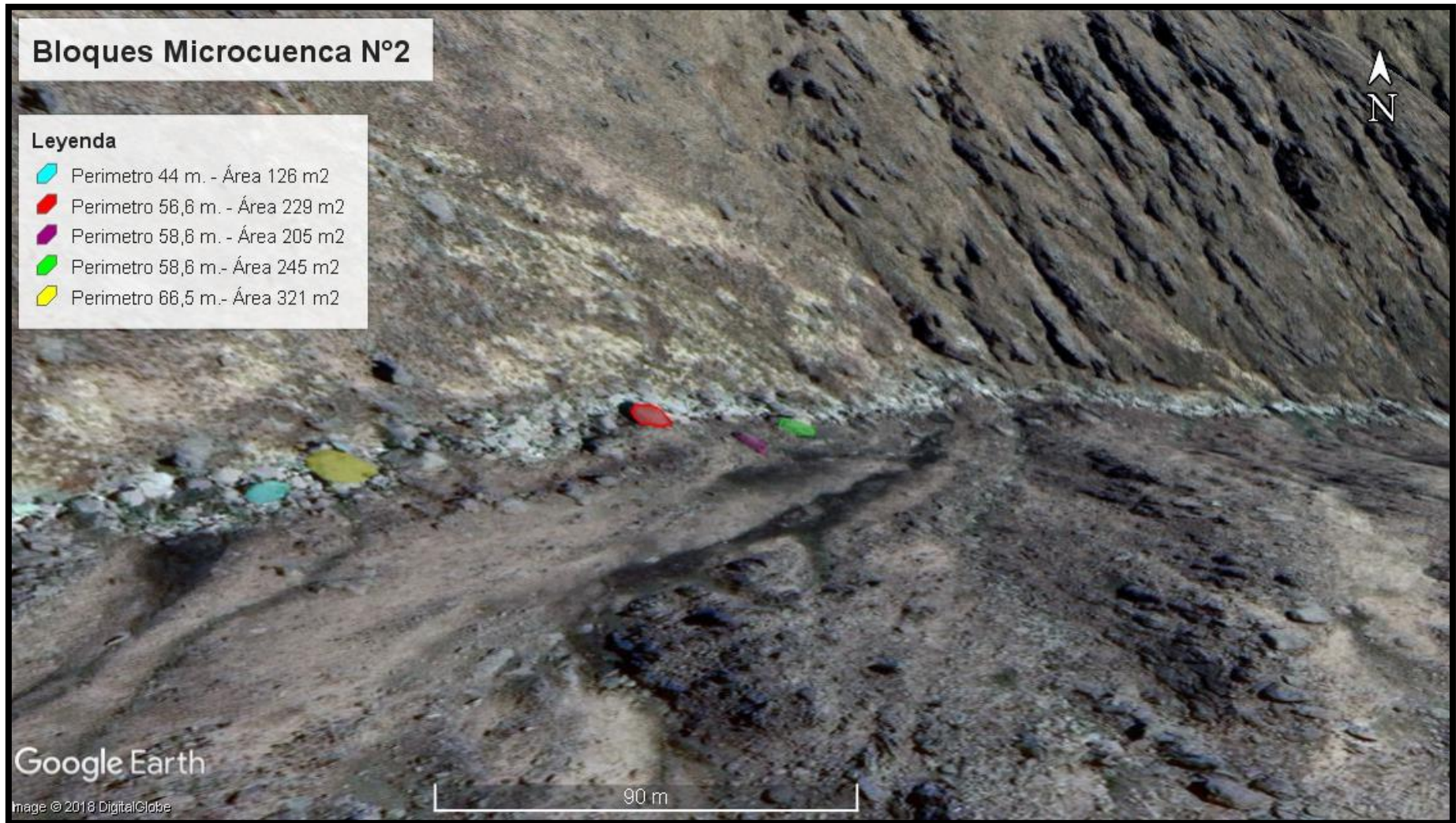
Figura 21: En la imagen se puede dimensionar el tamaño de los bloques que se transportan hacia el colector principal.
