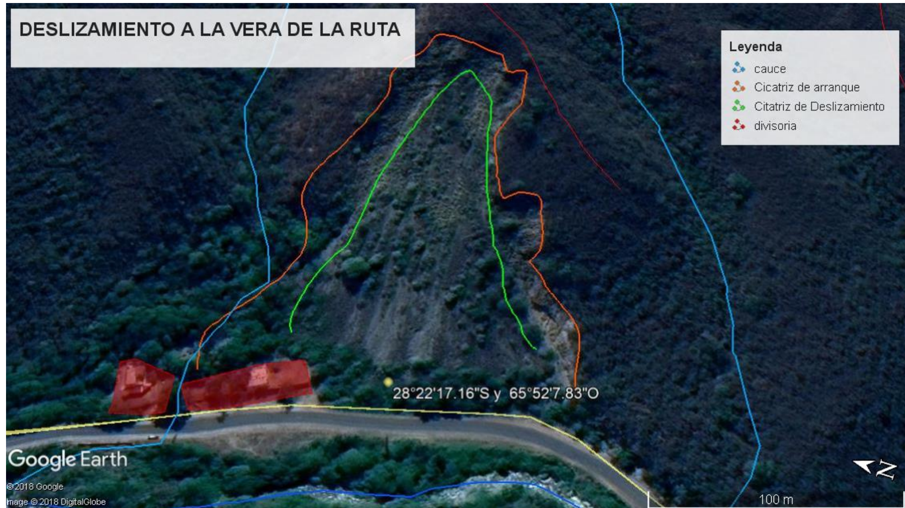
Figura 53: Deslizamientos de laderas en la zona cumbre de la subcuena media
