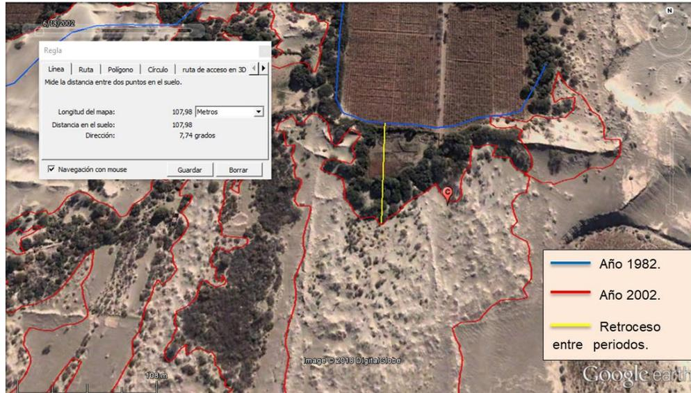
Figura N° 45: Retroceso del Frente “C” del médano entre los periodos 1982 y 2002.
