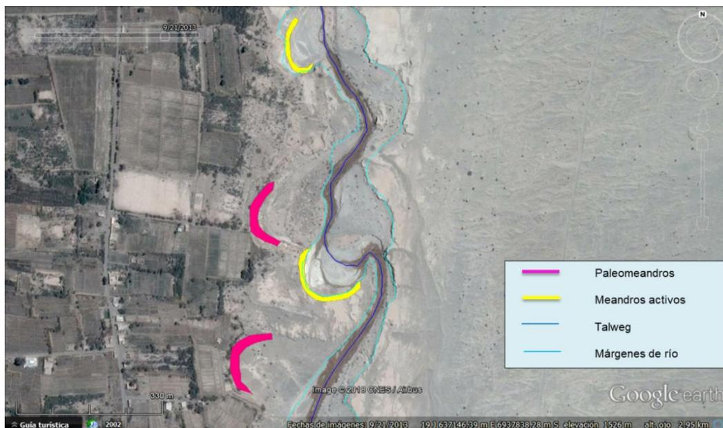
Figura N° 55: Meandros abandonados y Paleomeandros del Río Abaucán en el sector sur de la localidad de Fiambalá, año 2013.
