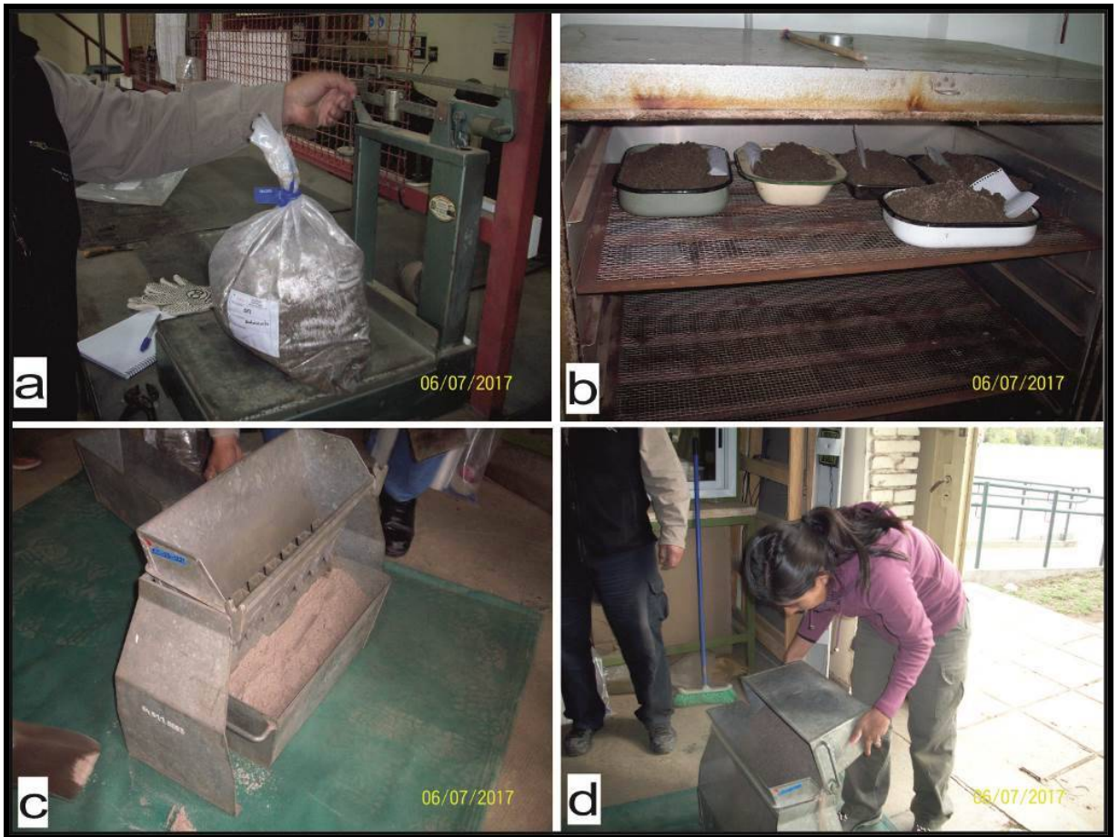
Figura 13: a. Pesaje inicial de las muestras. b. Distribución de las bandejas en el horno de secado a una temperatura de 60°C. c. Cuarteador de muestras para agregado fino. d. Proceso de cuarteo mecánico de muestras.
