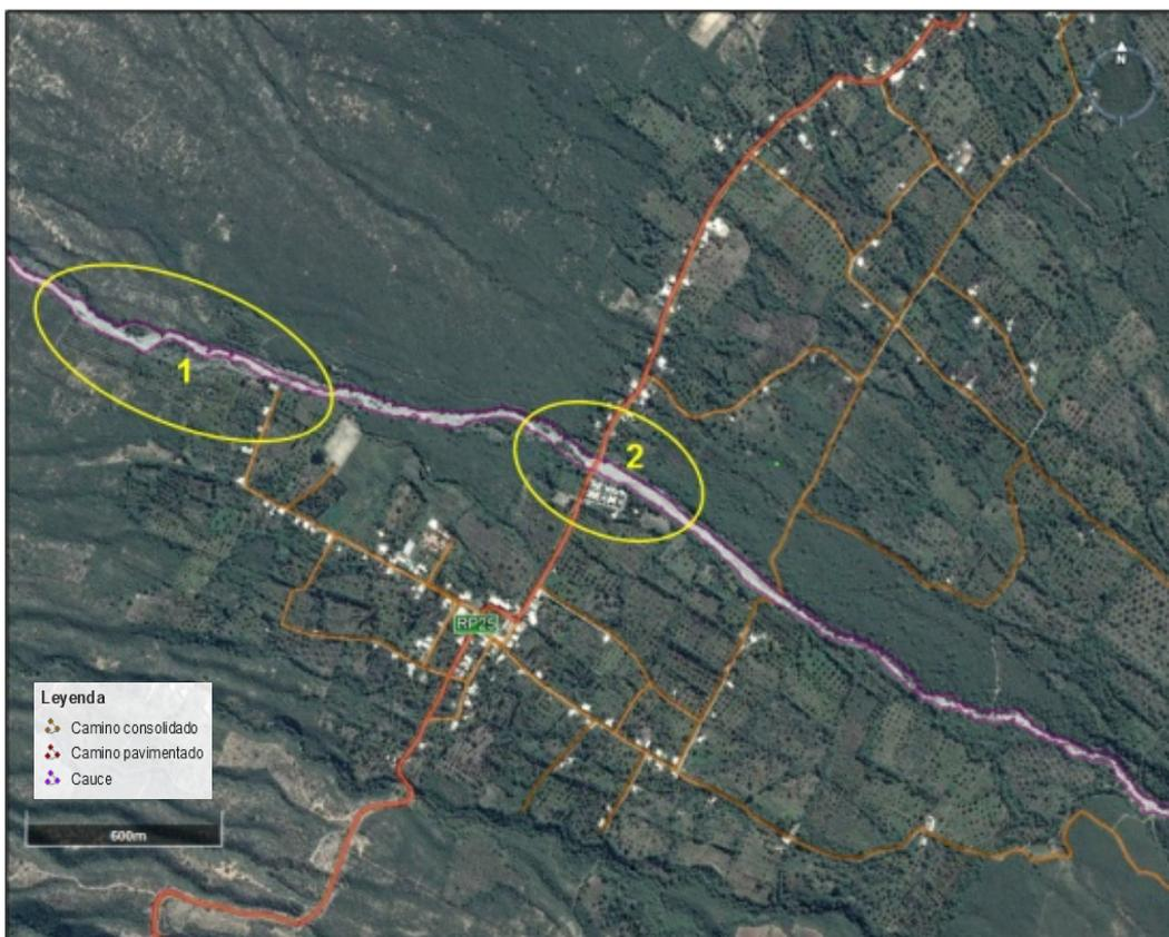
Figura N° 31: Sector de Colana. Tramos 1 y 2 de las zonas con evidencias de geoamenazas hídricas sobre el río Colana. Fuente: Google Earth.
