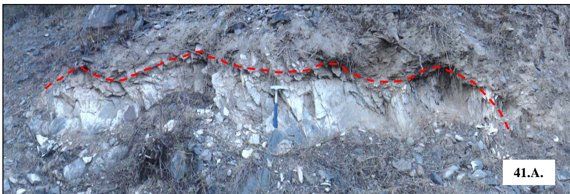
Figura 41. A. Afloramiento de esquisto bandedado fino en contacto (delineado rojo) con depósitos coluviales.
