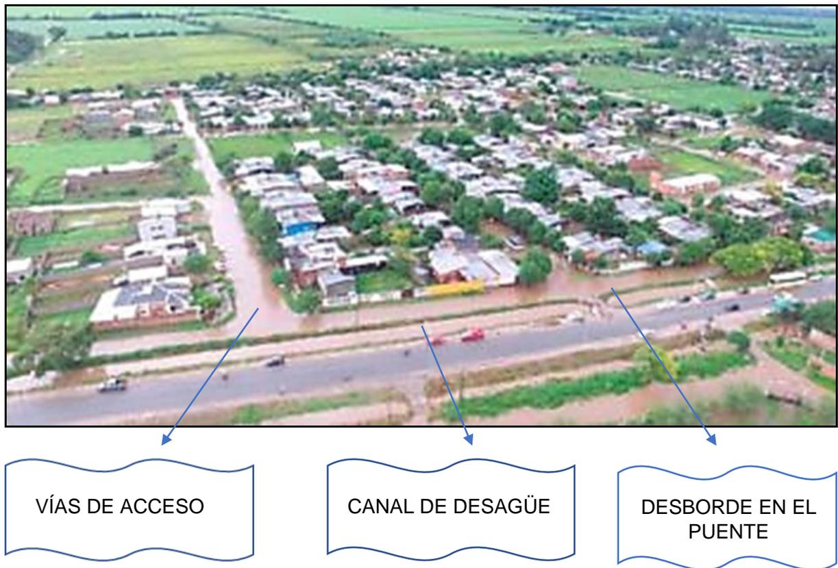
**Figura 47.** Barrió Belgrano de la ciudad de J. B. Alberdi afectados por las aguas en abril del 2017 producto del desborde del canal de desagüe a la altura del puente de acceso.
