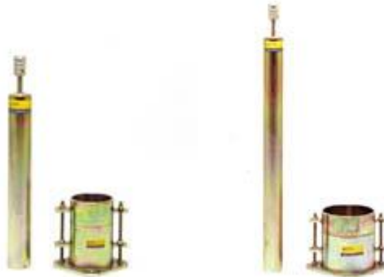
Figura 15: Moldes y pisones utilizados para el ensayo fuente: Mecánica de suelos. tomo I y II. ed. limusa.
