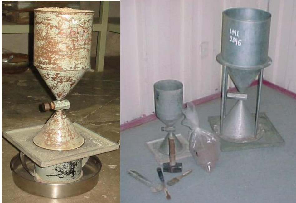
Figura 16: Instrumental para ensayo método de cono de arena fuente: Mecánica de suelos Juárez Badillo y Rico Rodríguez
