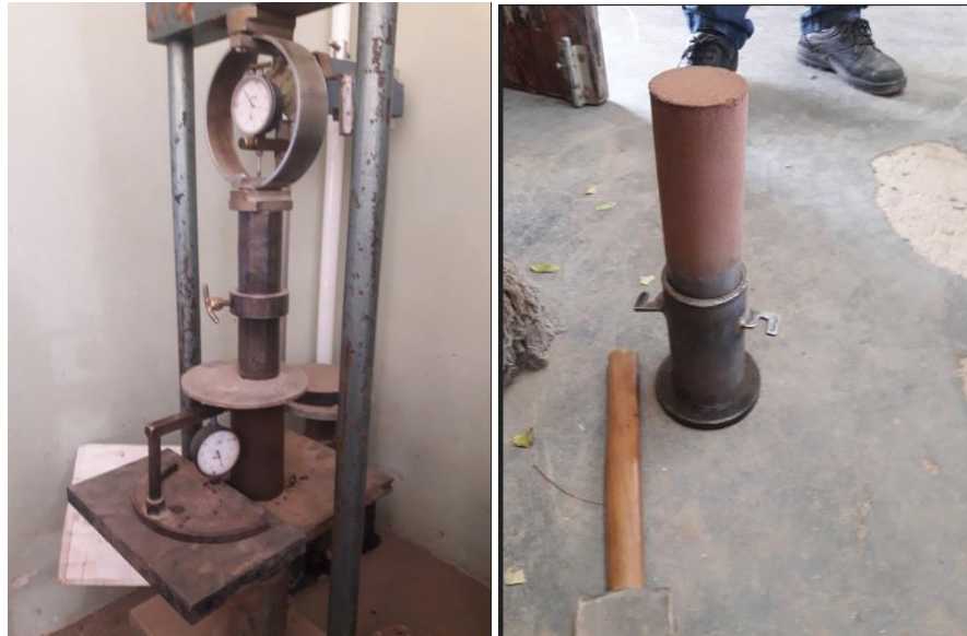
Foto 8: Prensa y probeta de ensayo para compresión simple
