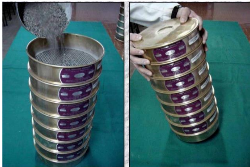
Figura 10: Set de tamices, fuente: Geotecnia III Ing. Augusto J. Leoni.
