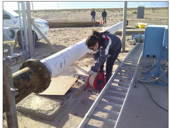
Foto 5 y 6: Monitoreo de la profundidad de los niveles de agua de los pozos CMW3 y CMW10B.
