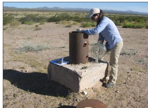
Foto 7 y 8: Monitoreo de la profundidad de los niveles de agua de los pozos CMW6B y CMW9.
