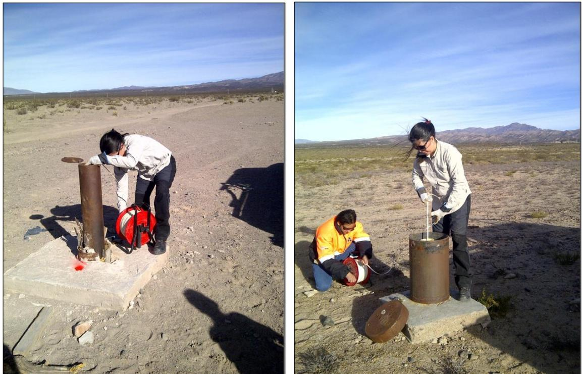
Foto 1 y 2: Medición de la profundidad del nivel de agua en el pozo CMW 13 y CMW 12.
