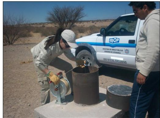
Foto 9 y 10: Monitoreo de la profundidad de los niveles de agua de los pozos ARM 10A y CMW 8.
