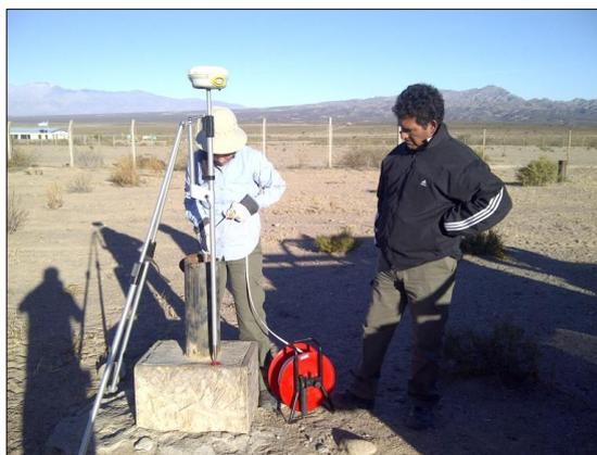
Foto 11 y 12: Relevamiento Planialtimétrico de Pozos y Medición del nivel.
