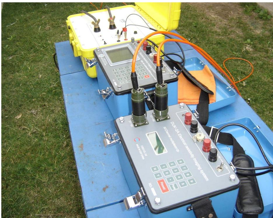
Foto 1: Equipo de geoelectricidad digital en corriente continua.
