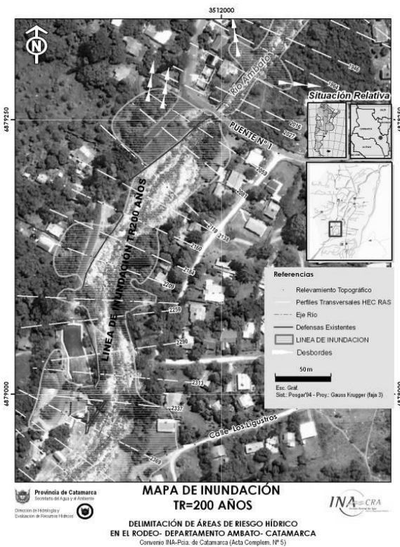
< Figura 5. Manchas de inundación generada por desbordes del cauce del Río Ambato
