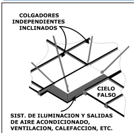
< Figura 2. Detalle de intervención en sistema de iluminación, a fin de reducir su vulnerabilidad sísmica
