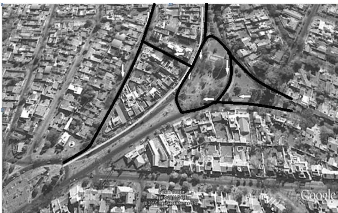
Figura 2: Zona de riesgo hídrico. En negro circulación normal de aguas. En blanco canalización propuesta para evitar el meandro.
