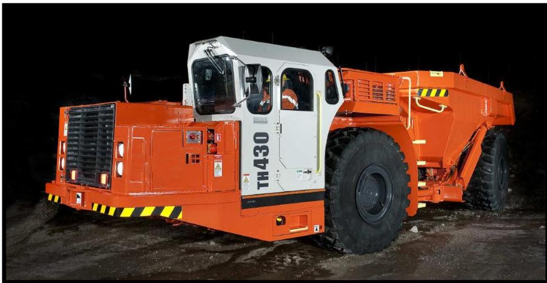
*Imagen 40: Camión de bajo perfil Dumper.*
