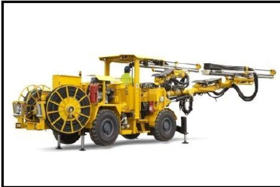
Imagen 17: Equipo de perforación horizontal, Jumbo electrohidráulico de dos brazos
