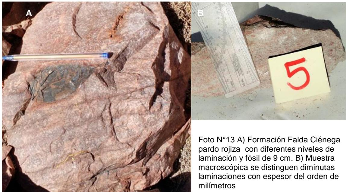
Foto N°13 A) Formación Falda Ciénega pardo rojiza con diferentes niveles de laminación y fósil de 9 cm. B) Muestra macroscópica se distinguen diminutas laminaciones con espesor del orden de milímetros
