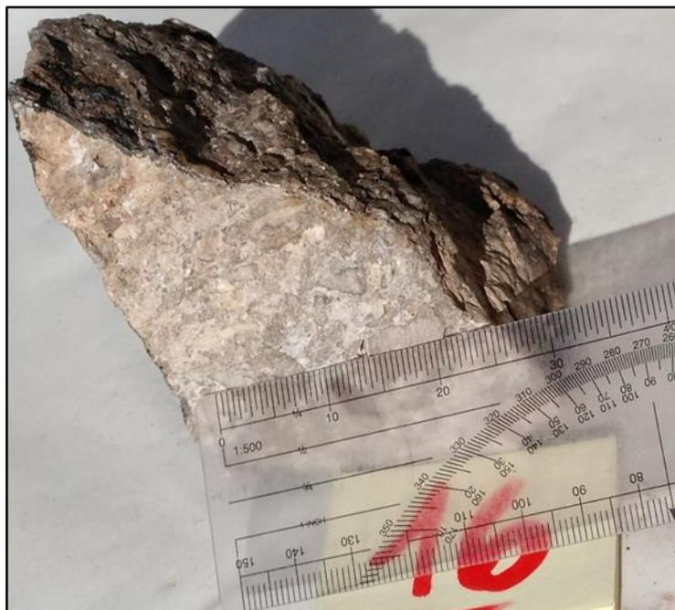
Foto N°21- Muestra macroscópica - Dacita con fragmentos de lapilli
