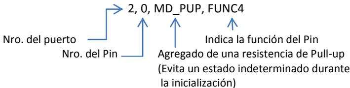
En la siguiente tabla (extraída de la tabla 184. "LPC4350/30/20/10 pin description" del manual del usuario del LPC43xx) se puede ver el significado de incorporar FUNC4 entre los parámetros de la función `Chip_SCU_PinMux`
