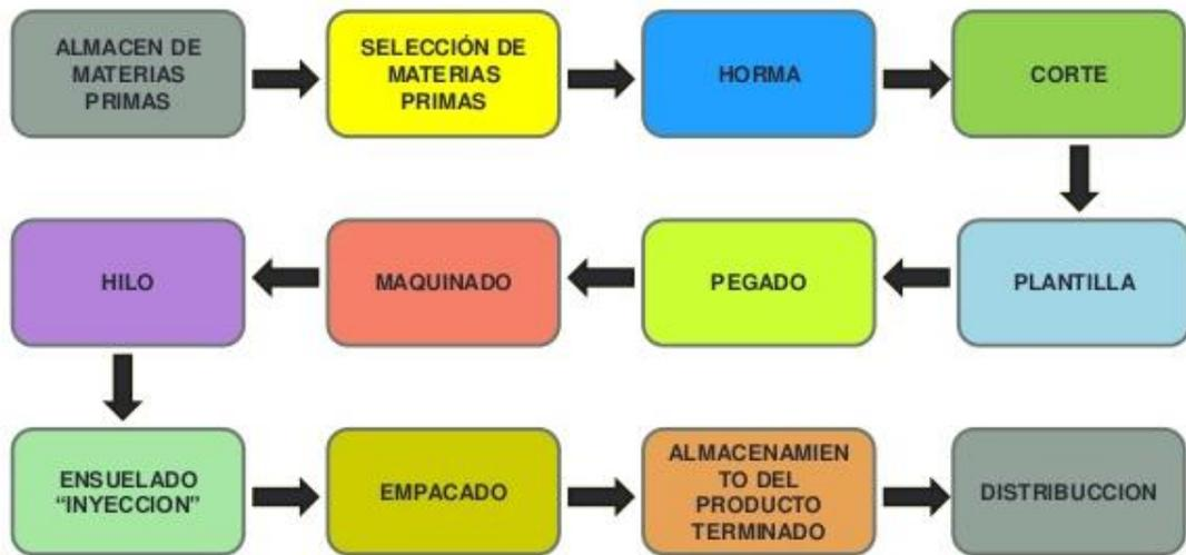
Diagrama 1. Diagrama de procesos fabricación de calzado
