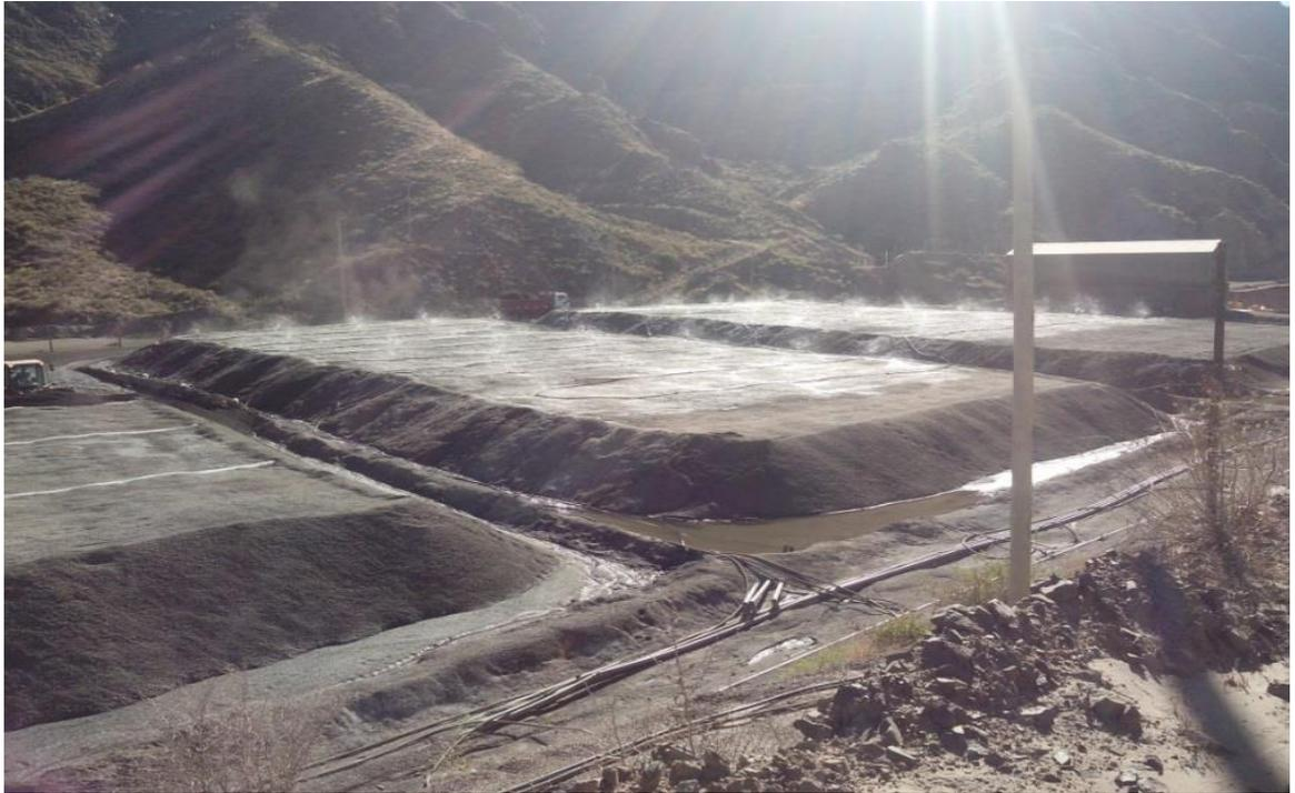
**Figura N°12: Playa de Lixiviación de Farallón Negro donde se muestra el riego.**
