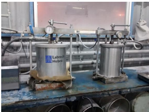
Figura 3-23- Filtros de presión Hebro
