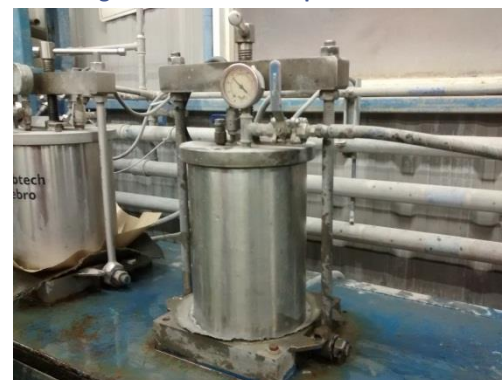
Figura 3-24- Filtración de concentrado
