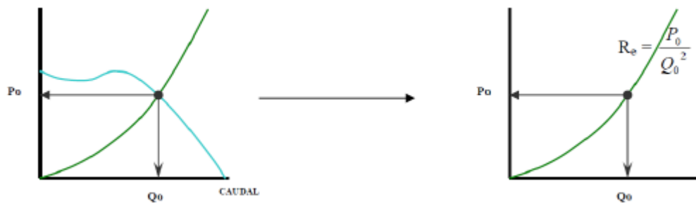
Figura 23: Punto de Corte de la Curva del Ventilador con la Resistencia del Circuito
