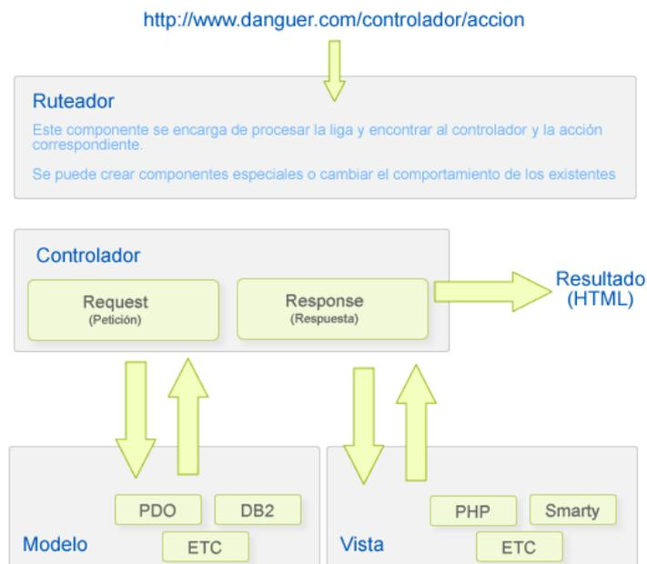
Figura 1. Esquema MVC (Modelo - Vista - Controlador)
