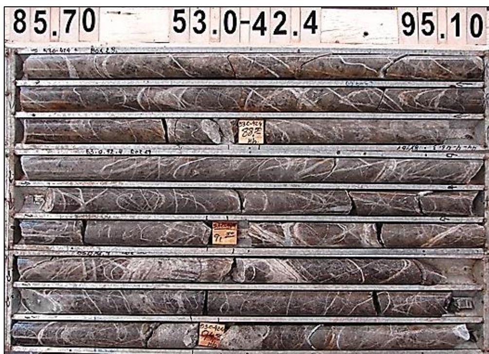
Figura 9-3: Fotografías de testigos diámetro HQ, sondeo 53.0-42.4; 85,70 m a 95,10 m. Alt ADF moderada a fuerte sobreimpuesta sobre alteración K, con >>Ser-arcilla-Cb sobre Pl; Qz-Ser en matriz parcial Ser-Chl sobre mafitos y en halos en vn tipo D. Vn tipo D cortan a 40-50° con respecto al eje del testigo. Vetillas de Gp entre 7% y 10%.
