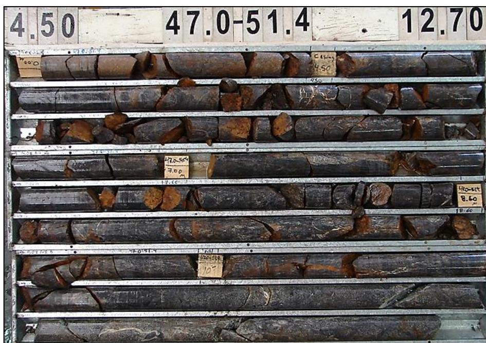
Figura 8-26: Fotografías de testigos diámetro HQ, sondeo 47.0-51.4. Intrusivo P2 con fuerte intensidad de vetillas cuarzo-magnetita (25-30%).
