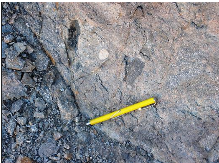
Figura 8-14: Brecha ígnea o intrusiva aflorante ( \approx 45 \times 55 m) en el sector central del depósito, hacia el NNE del stock principal P2. Contiene clastos de pórfido P1 (grano fino oscuro) y P2 (grano grueso oscuro) y fragmento de cuarzo redondeado.
