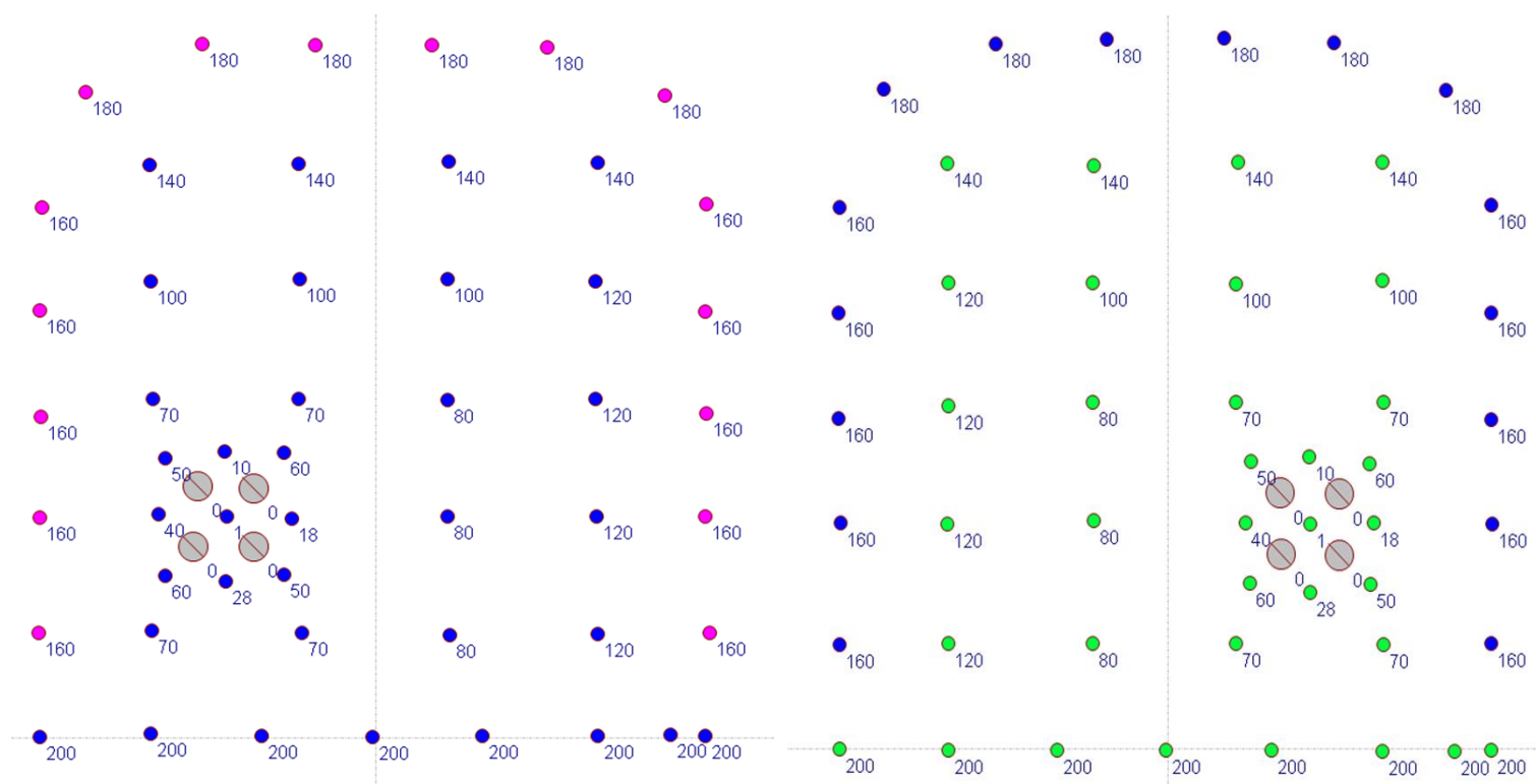
Figura 32. Secuencia de Detonación Arranque Izquierda/Derecha estándar Vetas Marianas y Eureka para el análisis
