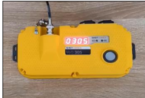
Figura 87. Conexión del cable al equipo
