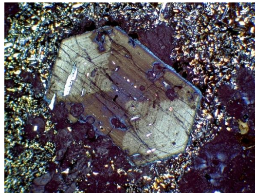
Figura 104. Zonaciones concéntricas en un cristal automorfo de augita. Luz polarizada plana, arriba; nicoles cruzados, abajo. (Gil-Crespo, Atlas de Mineralogía Óptica, 2022)
