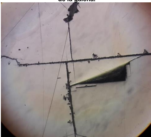
Figura 138. Galena reemplazada por Cerusita a lo largo del clivaje cúbico.
