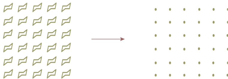
Figura 8. Motivos atómicos en un arreglo ordenado de una red de puntos (Ovejero, 2015).
