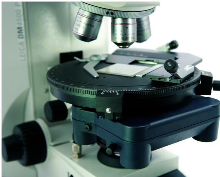
Figura 55. Platina graduada con carro y tornillos para sostén y movimiento de la muestra.
