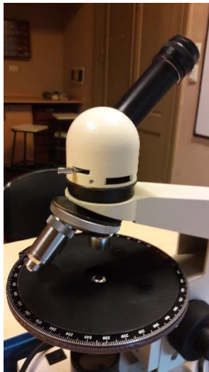
Figura 64. Ubicación de la Lente de Bertrand Amici en los microscopios empleados en clase.
