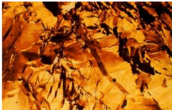
Figura 140. Microfotografías con nicoles paralelos (izquierda) y nicoles cruzados de Covelina masiva. Puede apreciarse el elevado pleocroísmo en tonos azules del mineral, así como los colores de polarización característicos en tonos anaranjados-cobrizos
