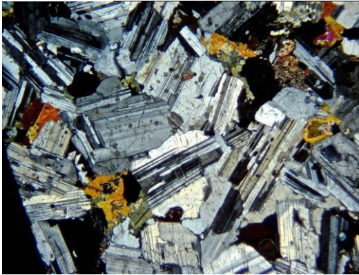
Figura 97. Imagen tomada con polarizadores cruzados. Maclas polisintéticas en cristales subautomorfos de plagioclasa. (Gil-Crespo, Atlas de Mineralogía Óptica, 2022).
