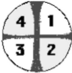
Figura 116. Cuadrantes de la figura de interferencia uniaxial
