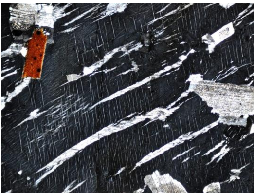
Figura 106. Micropertitas en un feldespato tipo microclina. Polarizadores cruzados. (Gil-Crespo, Atlas de Mineralogía Óptica, 2022).
