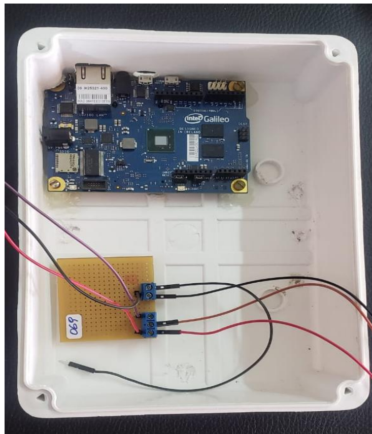
✓ Ajustes de la placa Intel® galileo Gen 1 y la Placa PCB
