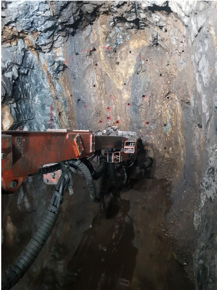
Figura 49 :Diagrama propuesto perforado- sección 4.1 m x 4.1 m
