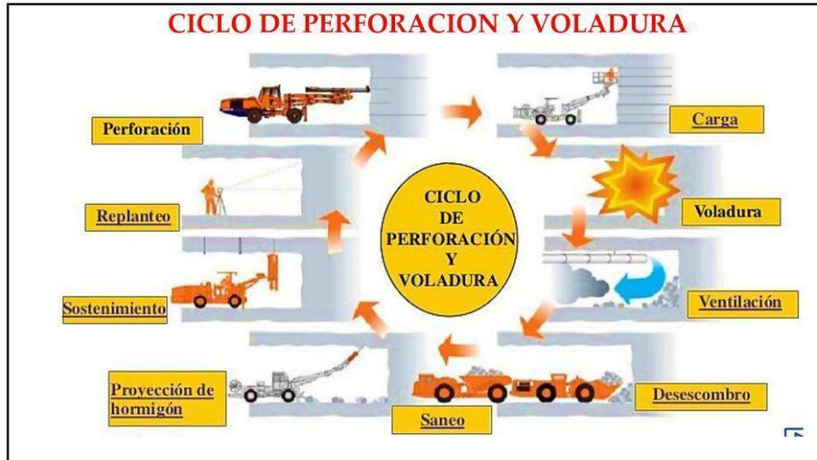
Figura 16: Ciclo de perforación y voladura en Frentes de avance.
