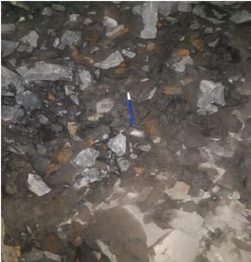
Figura 48: Fragmentación de la voladura – resultados post voladura diagrama estándar- sección 4.1 m x 4.1 m
