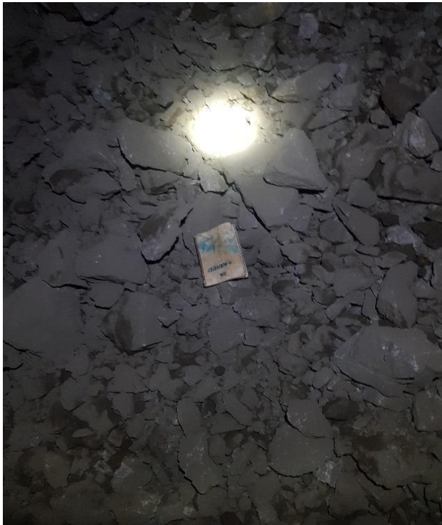
Figura 52: Fragmentación de la voladura – prueba 6 - sección 4.1 m x 4.1 m
