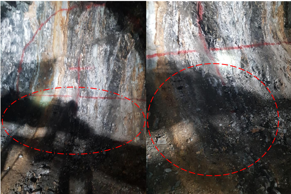
Figura 39: Imagen de pata post voladura-Diagrama estándar sección 3.8 m x 3.8 m
