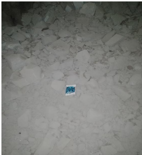
Figura 50: Fragmentación de la voladura – prueba 1 - sección 4.1 m x 4.1 m
