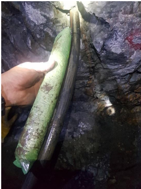
Figura 51: Medición de longitud de taco
