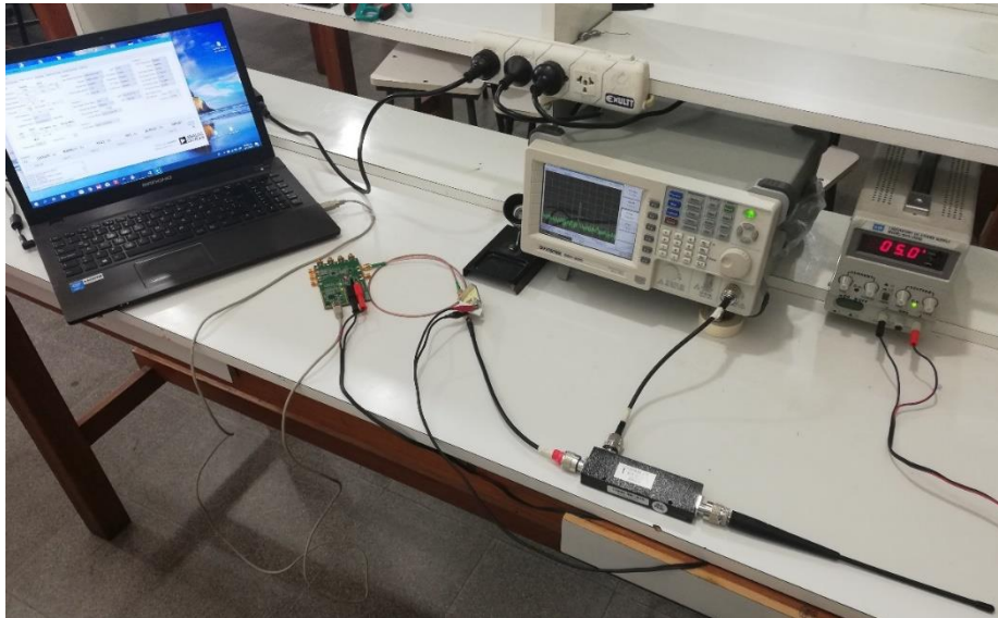
FIG. 69. CONEXIÓN PARA REALIZAR LAS MEDICIONES CON ANTENA COMERCIAL.
