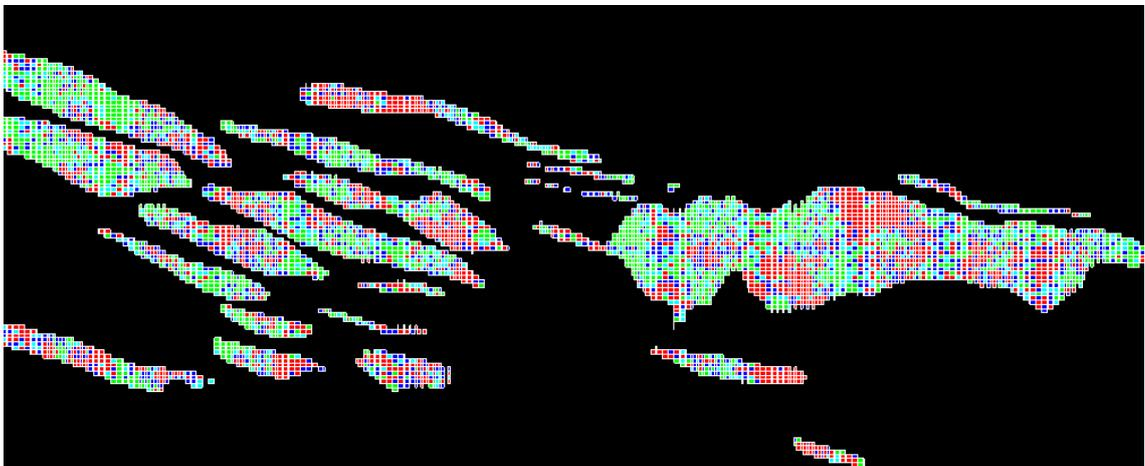
Imagen 25: Corte longitudinal del modelo de bloques, variable "simulación N°2", zona central de la mineralización.
