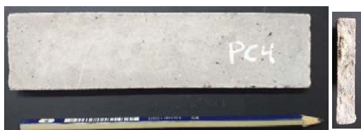
Figura 1. Probeta de mortero reforzado con fibra.
