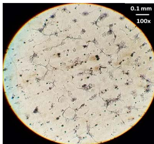
Figura 6. Muestra con hipertemple. No se observan carburos precipitados en borde de grano
