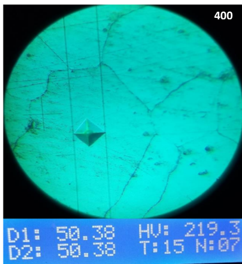
Figura 8. Dureza obtenida en la pieza con hipertemple.
