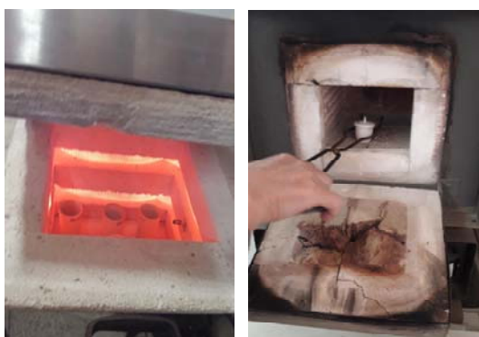
Figura 8. a. Mufla para cenizas. b. Mufla para volátiles.
