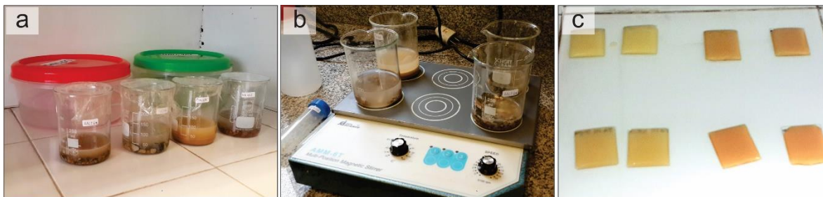
Figura 3.5. a: lavado químico (con peróxido de hidrógeno y ácido clorhídrico) de muestras sedimentarias; b: muestras agitadas mediante agitador magnético; c: secado al aire de muestras de arcilla de la fracción menor a 2 \mu\text{m} .
