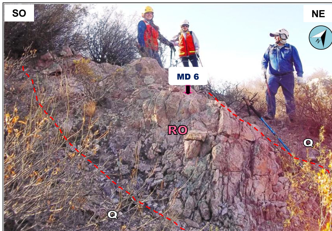
Figura IV.1.8: Afloramiento de posible Ignimbrita o Brecha rosa (RO) de la cual se extrajo la muestra MD6. Donde Q: detritos
