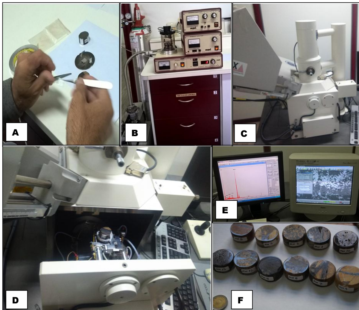
Figura III.9: Proceso de preparación de muestra para microanálisis con microscopio electrónica de barrido (MEB). A: Fotografía de preparación de probeta con cinta magnética. B: Fotografías de proceso de bomba de vacío y baño metálico. C: Equipo LEO 1450 VP, espectrómetro dispersivo de energía (EDS). D: EDS con probeta en su interior, inicio del análisis. E: Fotografía, imágenes generadas durante el proceso. F: Fotografía, probetas de vetas.
