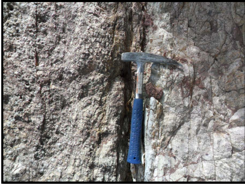
Figura N° 32. Contacto entre el granito de grano fino (a la derecha) y el pórfido (a la izquierda)
