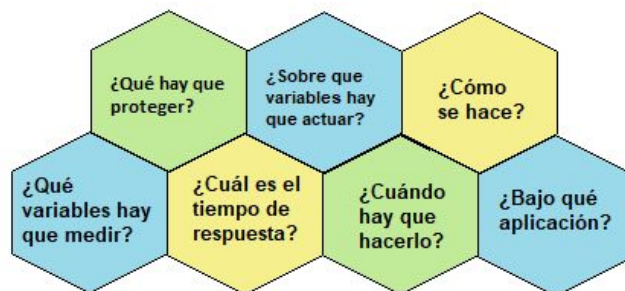
Fig. 2: Aspectos a considerar en la definición de una función instrumentada de seguridad funcional (SIF).
